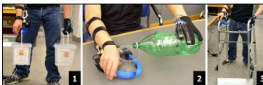
Σχήμα 1.5: Η χρήση των επιπρόσθετων ρομποτικών δαχτύλων ως συσκευή θεραπείας σε ημιπληγικούς ασθενείς κατά τη διάρκεια της αποθεραπείας [13].
