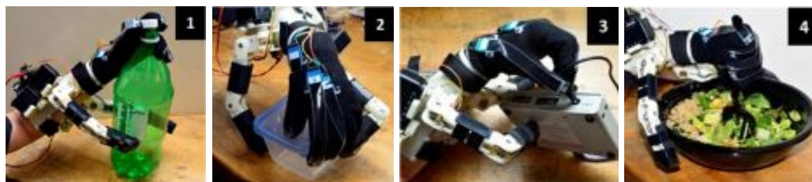
Σχήμα 1.4: Πειράματα επιβεβαίωσης των προτεινόμενων πρωτοκόλλων ελέγχου [12].
