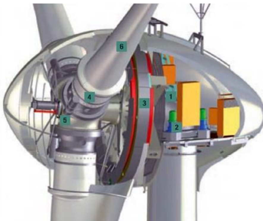
Εικόνα 11. Διάγραμμα της ατράκτου της κεφαλής. (1) Κύριος φορέας, (2) κινητήρας προσανεμισμού, (3) δακτυλιοειδής γεννήτρια, (4) ρυθμιστής περυγίου, (5) άξονας δρομέα, (6) πτερύγιο. Η πρόσβαση στο εσωτερικό της ατράκτου της κεφαλής γίνεται μέσω του πυλώνα, ενώ υπάρχει και θυρίδα στο πίσω μέρος της για ανεβοκατέβασμα φορτίων με μικρό γερανό. Με κίτρινο οι διάφορες υπομονάδες (box) [9]
