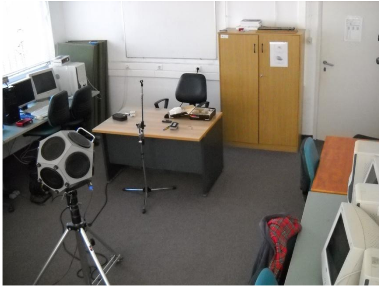
Φωτογραφία 4.2 Η αίθουσα με τοποθετημένο το δωδεκάεδρ ηχείο.
