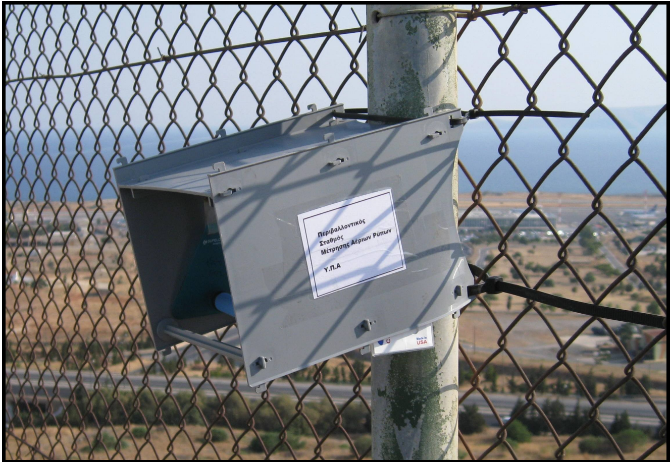
Εικόνα 6.1.2-2 Κάλυμμα προστασίας σωλήνων παθητικής προσρόφησης Radiello
