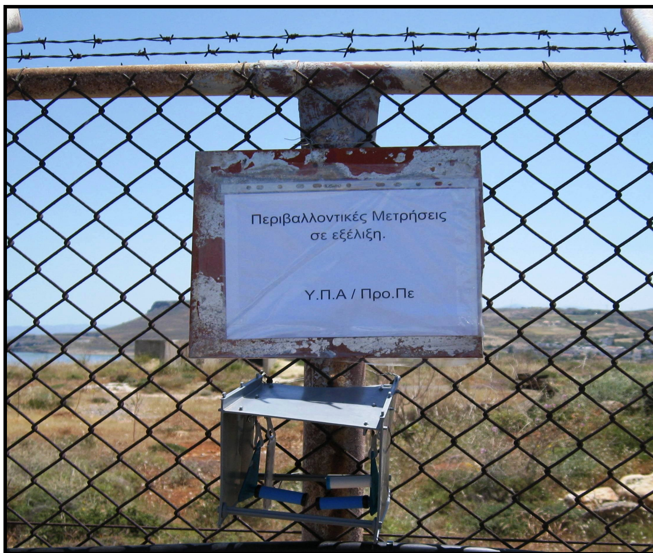
Εικόνα 6.1.2-1 Θέση ανάρτησης σωλήνων προσρόφησης Radiello
