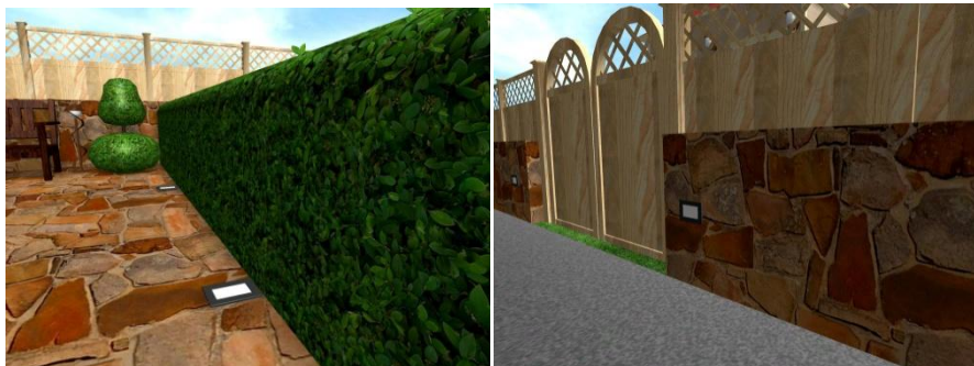
Εικόνα 35: Χωνευτά φωτιστικά σώματα στο πλακόστρωτο και στην περιφραγή.
