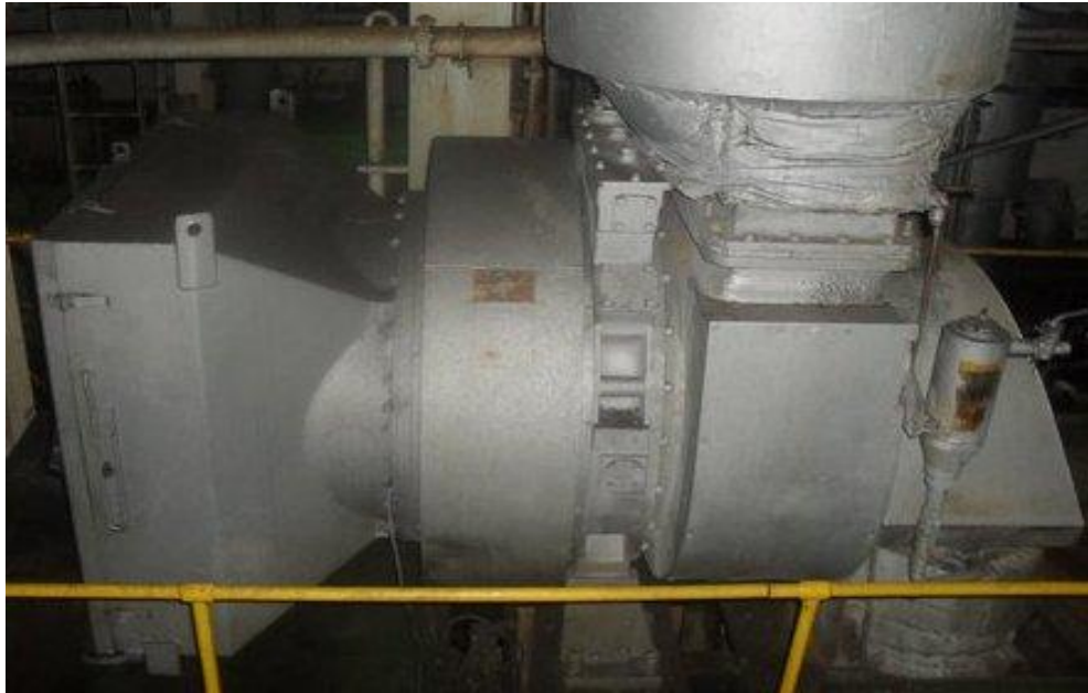
Εικόνα 5.3: Υπερσυμπιεστής Mitsubishi, MET53SC
