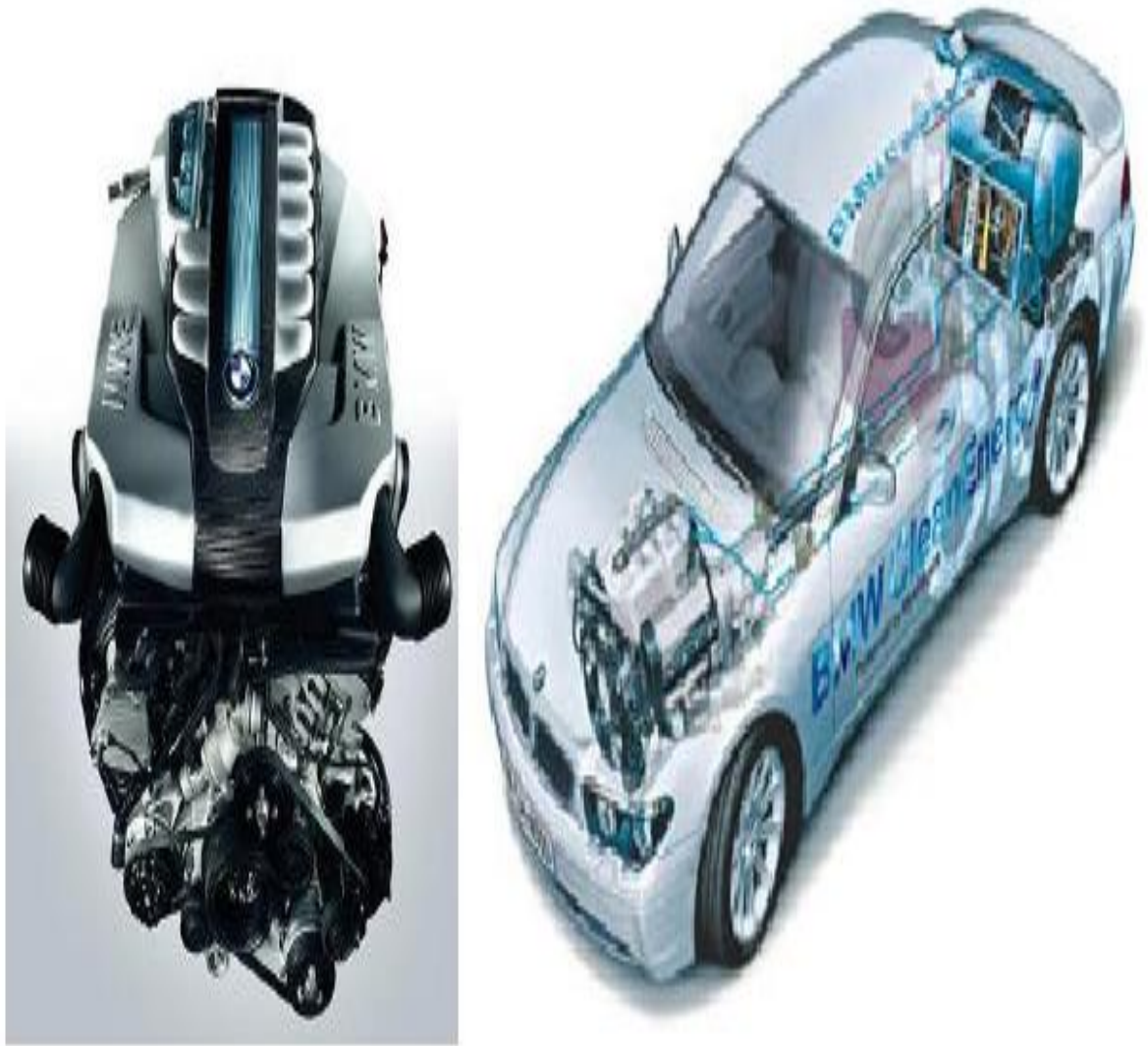
Εικόνα 5.15: Ο 12-κύλινδρος κινητήρας έξι λίτρων της BMW Hydrogen 7. Δεξιά διακρίνεται η διάταξη των μηχανικών συστημάτων όπως ο κινητήρας, το κιβώτιο ταχυτήτων, ο άξονας μετάδοσης και η δεξαμενή υδρογόνου.
