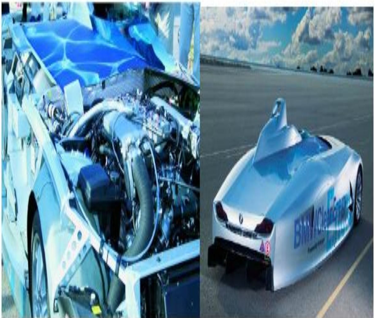
Εικόνα 5.13: Στην πρώτη εικόνα(επάνω) διακρίνονται ο κινητήρας καθώς και η δεξαμενή καυσίμου του πρωτότυπου H2R.
