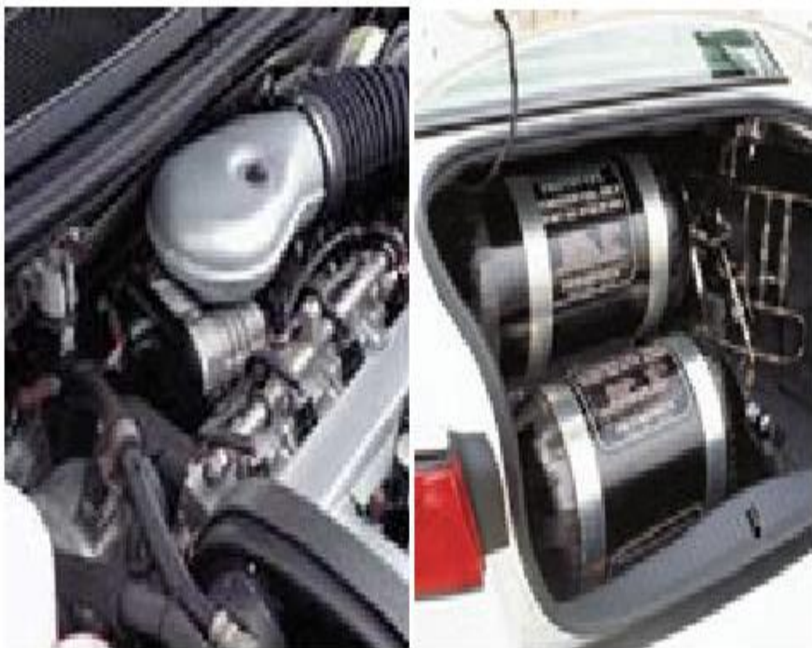
Εικόνα 5.17: Ο κινητήρας καύσης υδρογόνου και οι δεξαμενές καυσίμου στο χώρο αποσκευών του Ford P2000.
