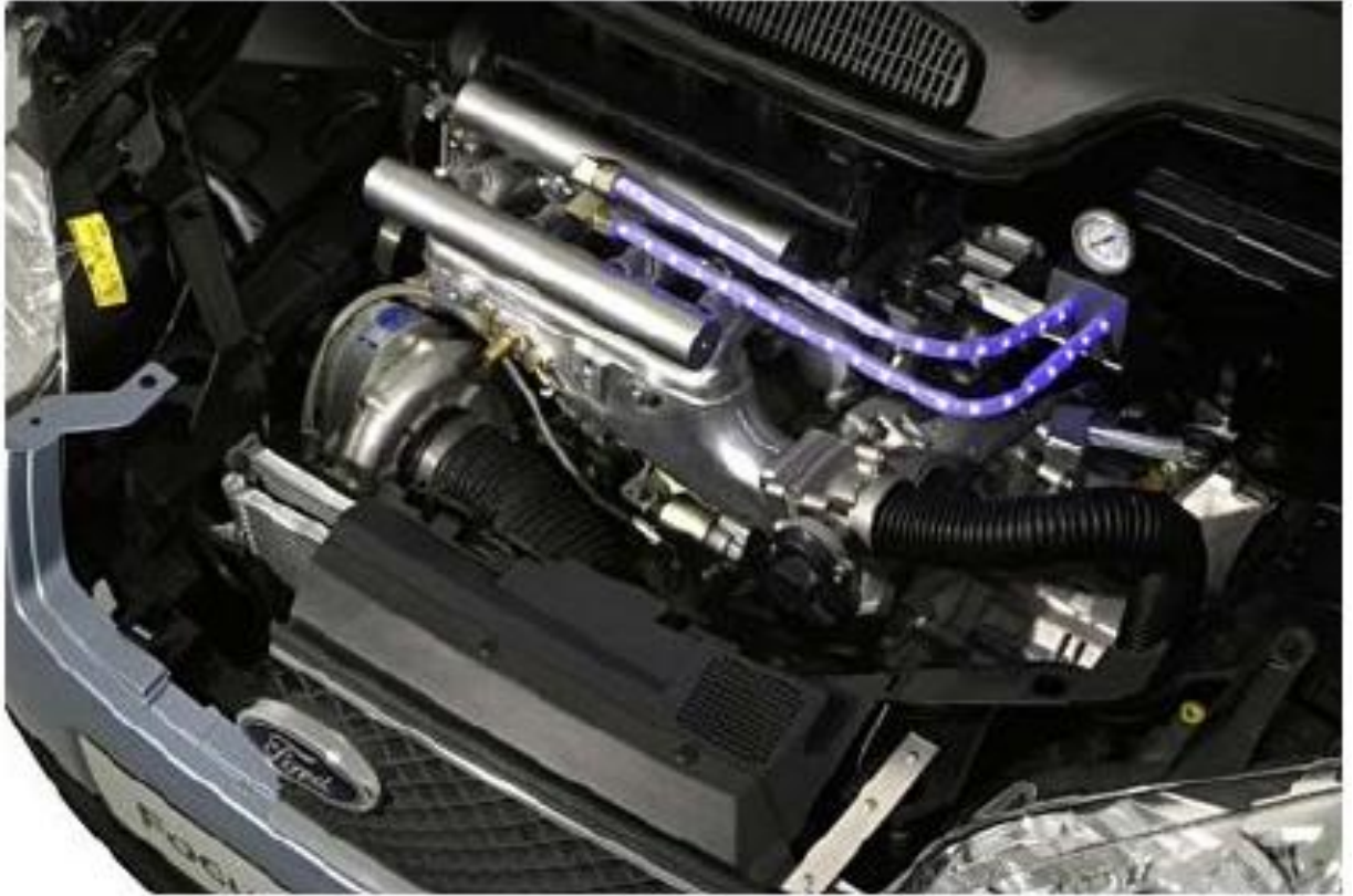
Εικόνα 5.20: Η μηχανή εσωτερικής καύσης υδρογόνου του Ford Focus C-Max H2ICE. Στη φωτογραφία διακρίνεται ο μηχανικός στροβιλο-υπερπληρωτής
