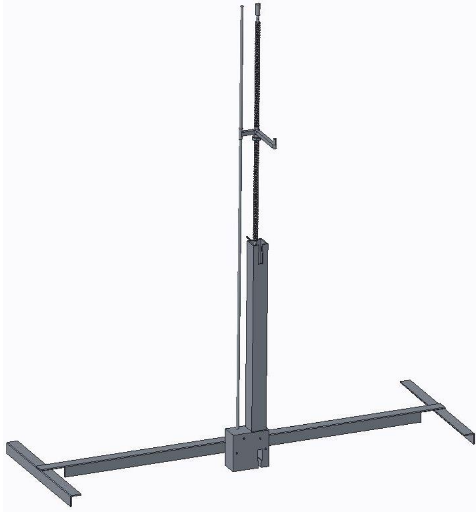
Σχήμα 9.27: Συναρμογή βάσης για την σάρωση των πτερυγώσεων με τους φακούς της κάμερας στραμμένους προς τα πάνω.
