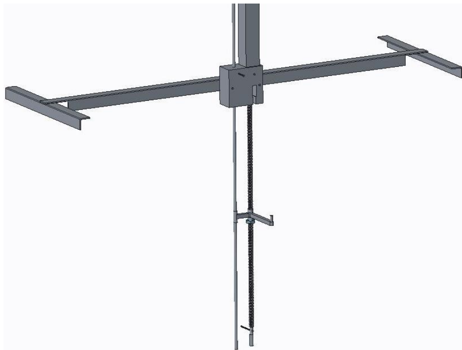
Σχήμα 9.30: Συναρμογή βάσης για την σάρωση των πτερυγώσεων με τους φακούς της κάμερας στραμμένους προς τα κάτω.
