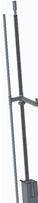
Σχήμα 9.29: Συναρμογή δοκών, ντίζας και βάσης βαθμονόμησης για την σάρωση των πτερυγώσεων με τους φακούς της κάμερας στραμμένους προς τα πάνω.
