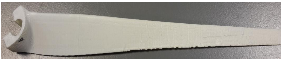
Σχήμα 6.3: Πτερυγώσεις ύστερα από την βαφή με σπρέι λευκό ματ χρώμα.
