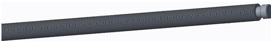
Σχήμα 9.4: Ατέρμονας κοχλίας (ντίτζα) κυλινδρικής διατομής για την μεταβολή του ύψους της πτερύγωσης.
