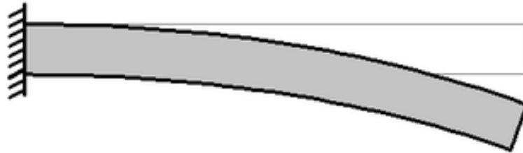
Σχήμα 5.7: Βέλος κάμψης δοκού τετραγωνικής διατομής όταν σε αυτή εφαρμόζονται καμπτικά φορτία.
