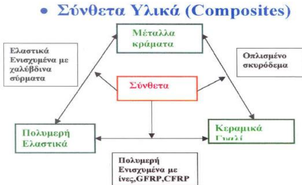
Εικόνα 28 Ταξινόμηση σύνθετων υλικών με βάση την κραματική δομή τους
