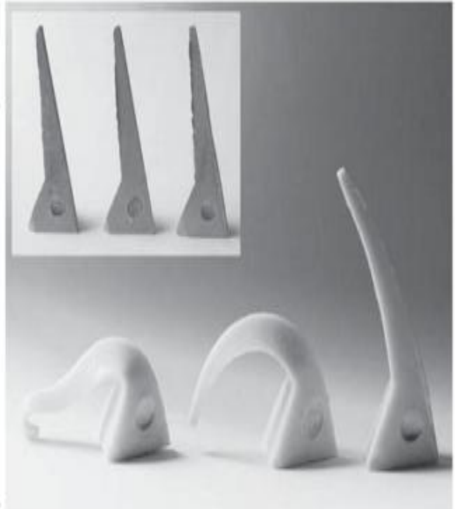
Εικόνα 24 Διαδικασία PCE(Pyrometric Cone Equivalent), δοκιμασίας θέρμανσης σε πυρίμαχα υλικά που έχουν δημιουργηθεί σε τριγωνικά σχήματα και κάμπτονται με τον χρόνο σαν τόξο
