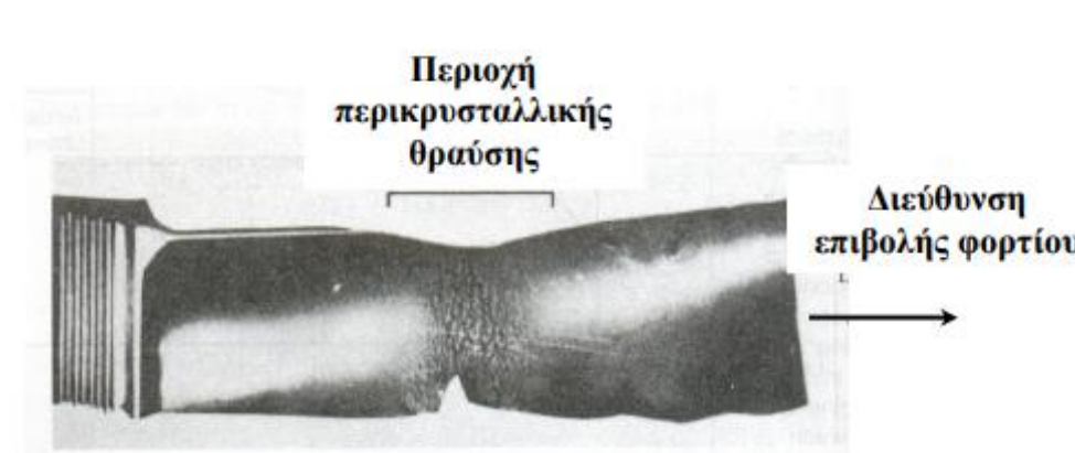
Εικόνα 10 Πτερύγιο στροβιλοκινητήρα που έχει επέλθει σε αστοχία λόγω των φαινομένων του ερπυσμού
