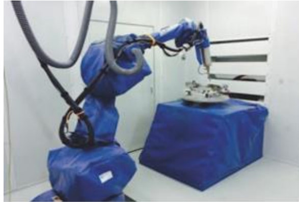
Σχήμα 39 Ρομποτικό όπλο ψυχρού ψεκασμού τοποθετημένο σε τυπικό βιομηχανικό ρομποτικό βραχίονα με το υπόστρωμα τοποθετημένο σε βραχίονά δύο βαθμών ελευθερίας (Able Engineering)
