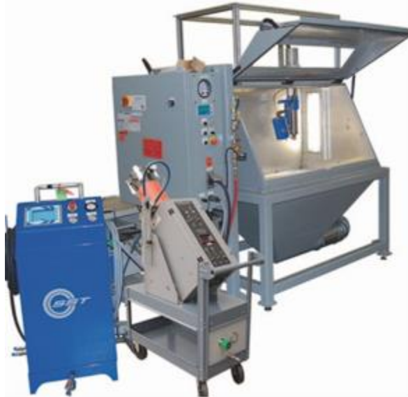
Σχήμα 31 Σύστημα έγχυσης κατάνη (15 kW / 34 bar / 550 ° C) με ενσωματωμένο ντουλάπι, εξαερισμό και βοηθητικά συστήματα για μηχανική λειτουργία.
