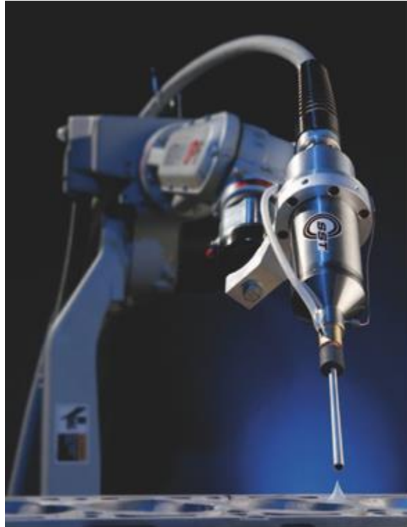
Σχήμα 38 Ρομποτικό όπλο ψυχρού ψεκασμού τοποθετημένο σε τυπικό βιομηχανικό ρομποτικό βραχίονα (CenterLine (Windsor) Limited)
