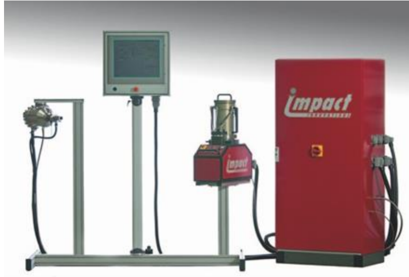
Σχήμα 34 Σύστημα ψεκασμού με ανάντη έγχυση (40 kW / 50 bar / 1100 ° C) που δείχνει τη μονάδα ελέγχου, το τροφοδότη σκόνης και το σύστημα ψεκασμού 40 kW. (Impact Innovations 2014)
