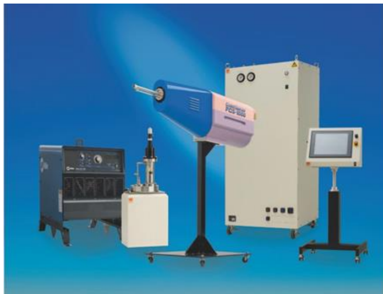
Σχήμα 35 Σύστημα έγχυσης ανάντη (70 kW / 50 bar / 1000 ° C) που δείχνει το σύστημα ψεκασμού 70 kW. (Plasma Giken Co.)
