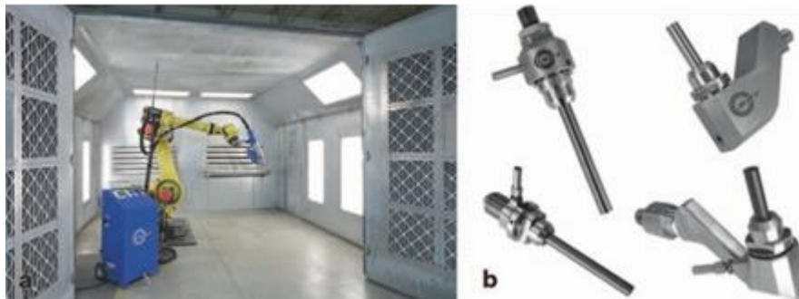
Σχήμα 32 Σύστημα έγχυσης κατάνη (15 kW / 34 bar / 550 ° C) με ενσωματωμένο θάλαμο ψεκασμού, εξαερισμό και βοηθητικά συστήματα για ρομποτική λειτουργία. Β Μορφοποιημένα ακροφύσια ψεκασμού ευθείας και 90 ° προς τα κάτω για πολλαπλές εφαρμογές.
