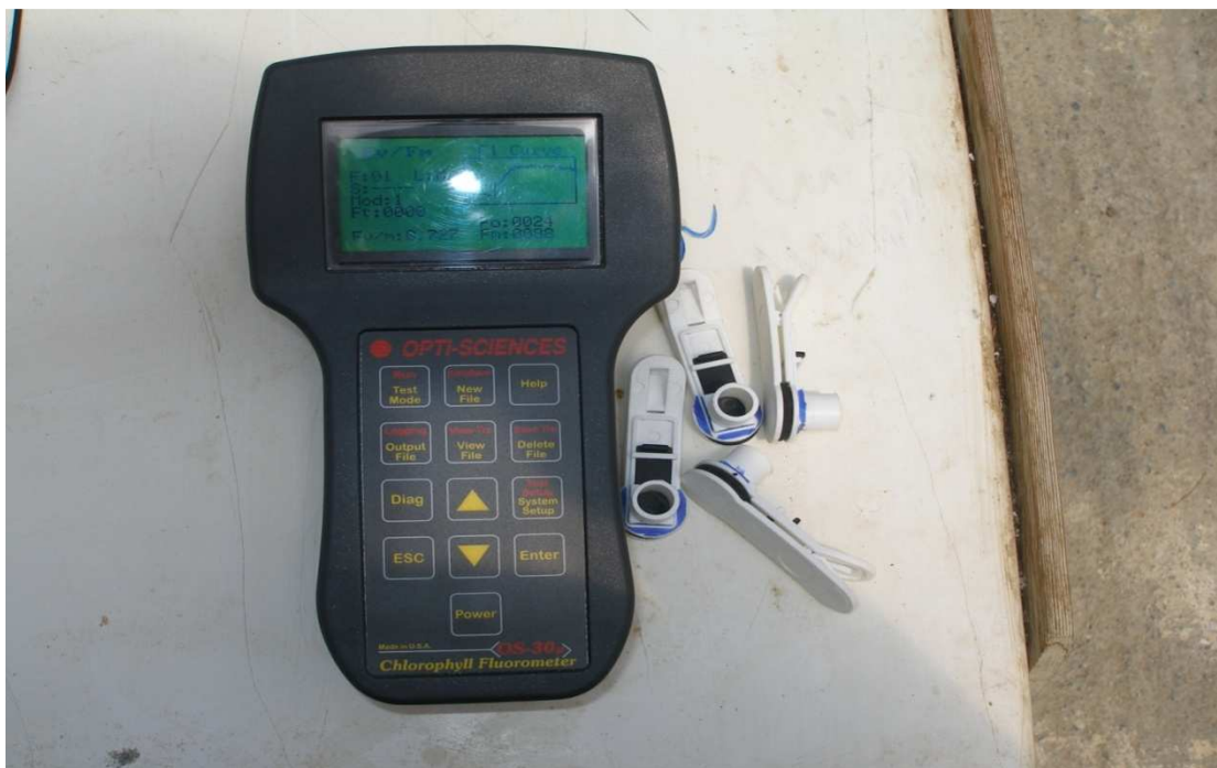
Εικόνα 4.24: Φθορίμετρο, opti-scences UK και τα ειδικά "μανταλάκια".
