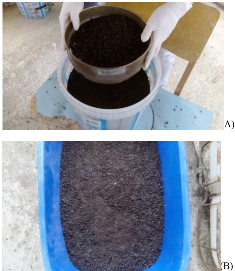
Εικόνα 13. (Α) Κοσκίνισμα μελισσοκομικού κεριού, (Β) Απομάκρυνση του αχώνευτου χονδροειδές υλικού.
