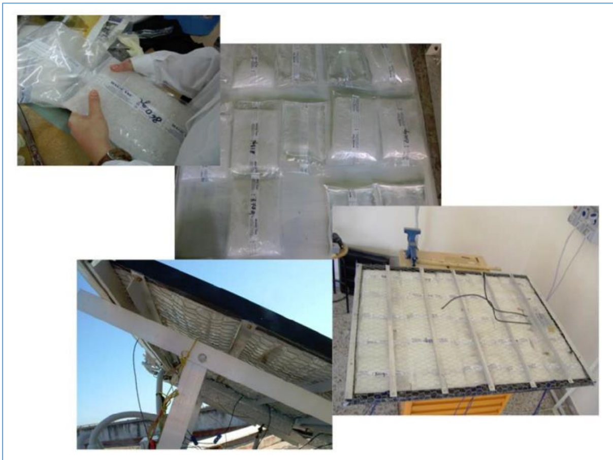
Εικόνα 3.19: Επιλογή υλικού αλλαγής φάσης και τοποθέτησή του στο πίσω μέρος του φωτοβολταϊκού πάνελ
