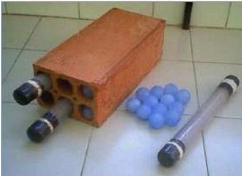
Εικόνα 2.14: Τούβλο 6 οπών, υλικό αλλαγής φάσης και σωλήνες
