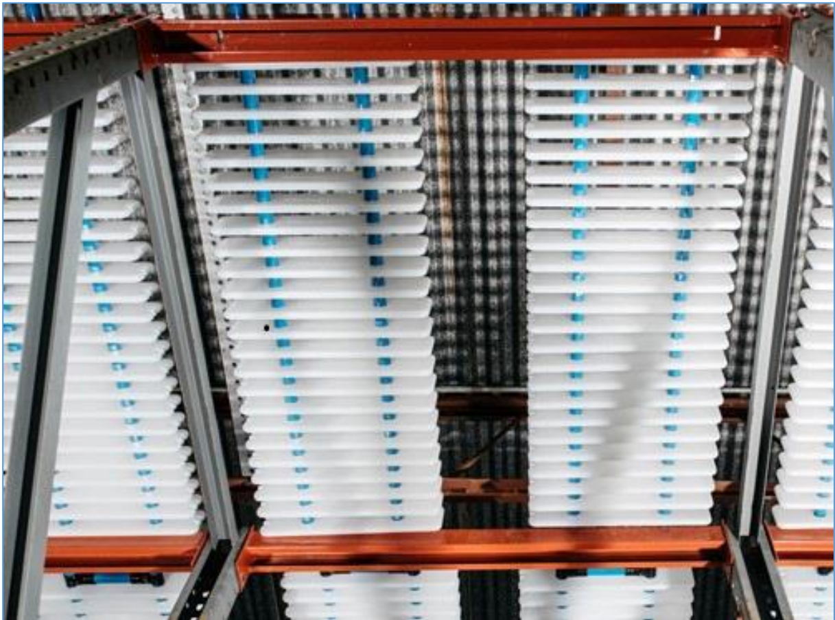
Εικόνα 3.16: Υλικά αλλαγής φάσης τοποθετημένα στο πίσω πλαίσιο φωτοβολταϊκού
