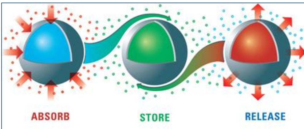
Εικόνα 1.1: Ο μηχανισμός λειτουργίας των υλικών αλλαγής φάσης
