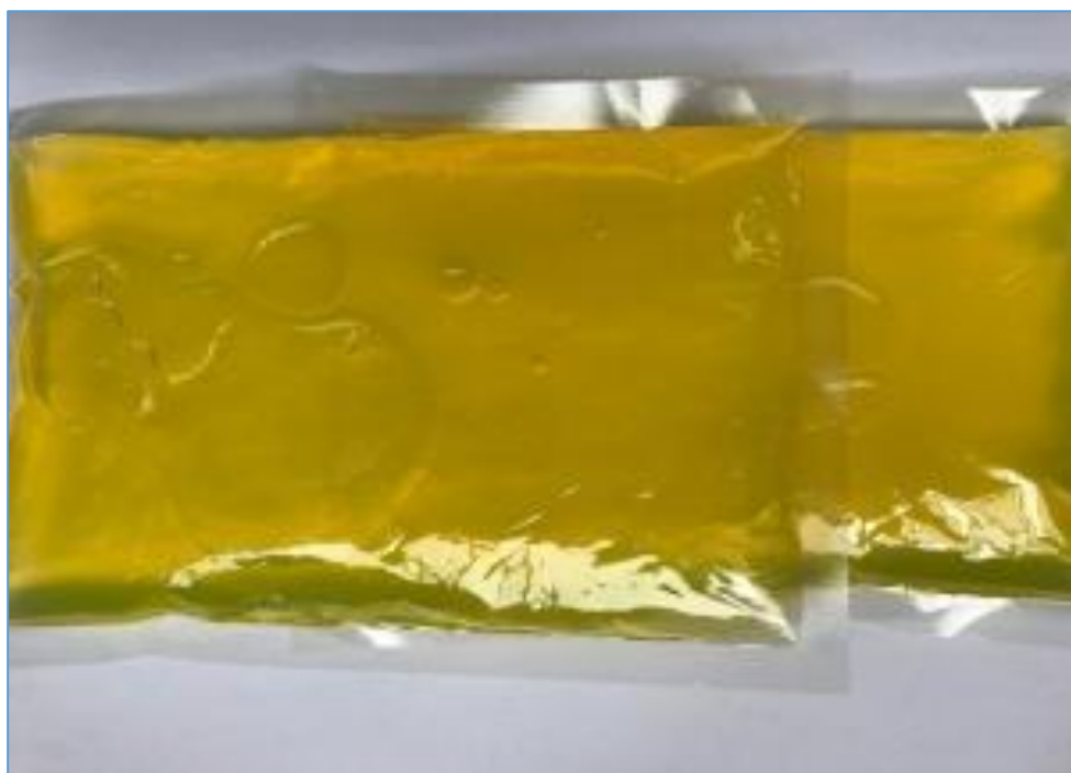
Εικόνα 3.10: Σύστημα υλικού αλλαγής φάσης για συσκευασίες με χρήση φυτικών ελαίων
