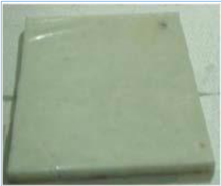
Εικόνα 2.17: Υλικό αλλαγής φάσης κατασκευασμένο από 75% παραφίνη και 25% πολυαιθυλένιο
