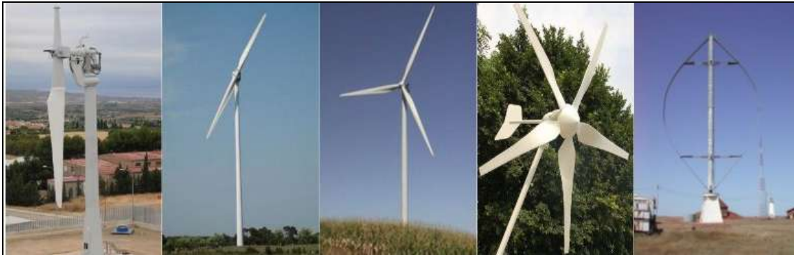
Εικόνα 17: Είδη ανεμογεννητριών (από αριστερά προς τα δεξιά, μονοπτέρυγη, διπτέρυγη, τριπτέρυγη, πολυπτέρυγη και κατακόρυφου άξονα).
