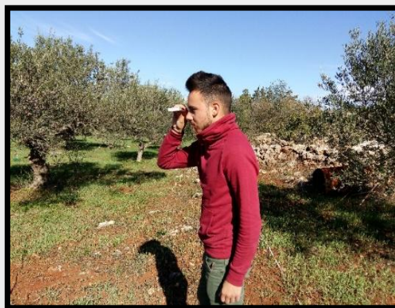
ΕΙΚΟΝΑ 34: Χρήση πυξίδων για τον προσανατολισμό κατά το άνοιγμα των καλωδίων TEM
