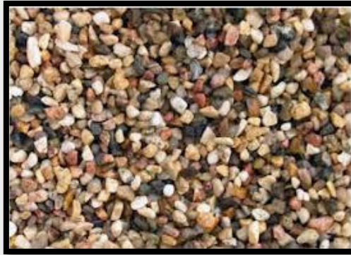
ΕΙΚΟΝΑ 3: Διαβαθμισμένο και αποστρογγυλομένο ποταμίσιο χαλίκι ως φυσικό φίλτρο νερού
