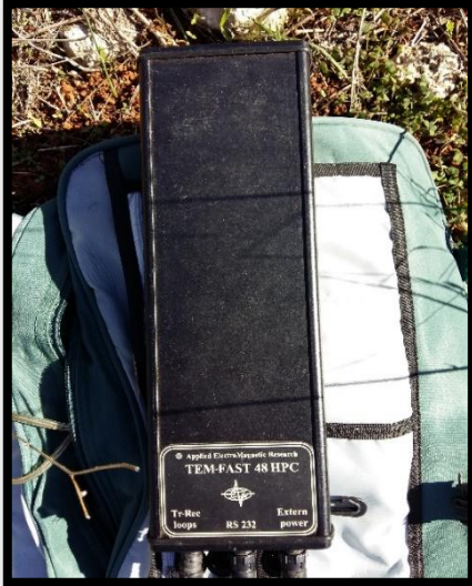
ΕΙΚΟΝΑ 31: Πομπός και καταγραφικό του δέκτη το οποίο βρίσκεται πάνω στο ίδιο όργανο
