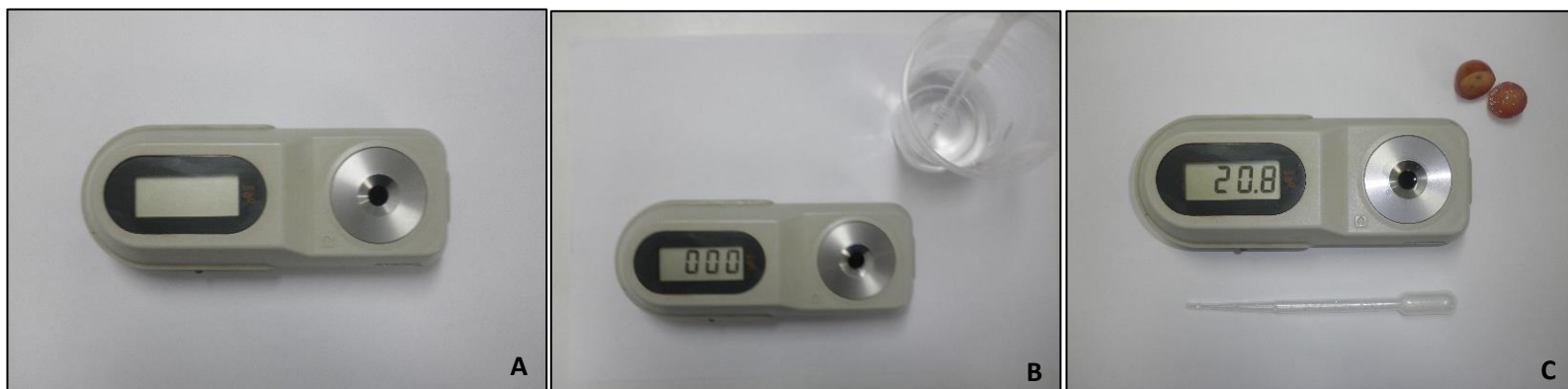
Εικόνα 4.55: Απεικόνιση του ηλεκτρονικού διαθλασίμετρου ATAGO PR-1 (εταιρίας ATAGO®, μοντέλου PR-1, χώρα παραγωγής την ΗΠΑ). A: Όταν είναι κλητό. B: Όταν μηδενίζεται το όργανο. C: Όταν γίνεται η μέτρηση των ολικών διαλυτών στερεών. (Λήψη φωτογραφίας με φωτογραφική μηχανή Canon.)
