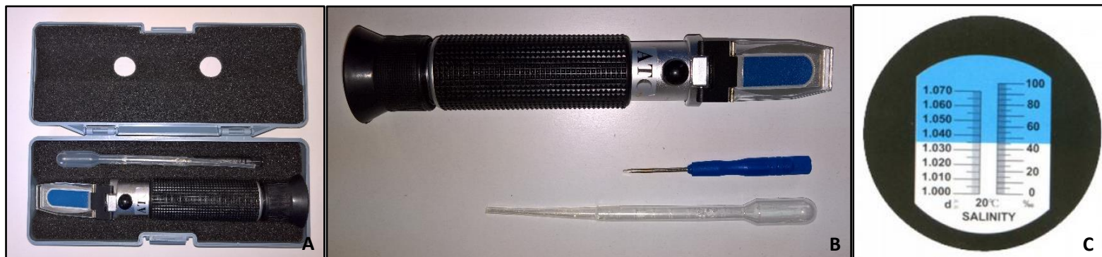
Εικόνα 4.56: Απεικόνιση του οπτικού διαθλασίμετρου – αλατόμετρου THE - 01502 (εταιρίας OEM®, μοντέλου THE - 01502, χώρα παραγωγής την ΗΠΑ). A: Μέσα στην συσκευασία. B: Μαζί με την πιπέτα μηδενισμού και την βελόνα δειγματοληψίας (διάτρησης καρπών για την παραλαβή του χυμού). C: Οι 2 ο κλίμακες μέτρησης, όπως φαίνονται στον οπτικό θάλαμο. (Λήψη φωτογραφίας με φωτογραφική μηχανή Canon.)
