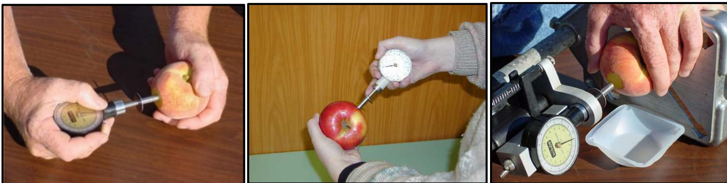
Εικόνα 1.35: Απεικόνιση του φορητού πιεσόμετρου «Magnes-Taylor», εφαρμοσμένο πάνω σε καρπό ροδάκινου (A) και μήλου (B). Το φορητό πιεσόμετρο εφαρμοσμένο πάνω στην βάση του πιεσόμετρου κατά την μέτρηση σε καρπό ροδάκινου (C).
