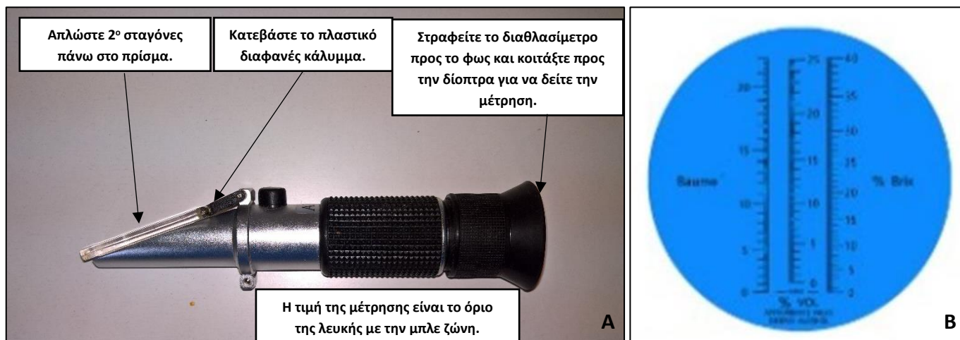
Εικόνα 4.54: Απεικόνιση του οπτικού διαθλασίμετρου FERRARI FG-514 (εταιρίας FERRARI®, μοντέλου FG-514, χώρα παραγωγής την Ιταλία). A: Με τις οδηγίες μέτρησης των ολικών διαλυτών στερεών (συντ. ΟΔΣ). B: Οι 3 η κλίμακες μέτρησης, όπως φαίνονται στον οπτικό θάλαμο. (Λήψη φωτογραφίας A με φωτογραφική μηχανή Canon.)
