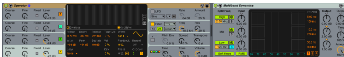
Εικόνα 10: γεννήτρια ήχου sine σε σειρά με έναν multiband compressor
