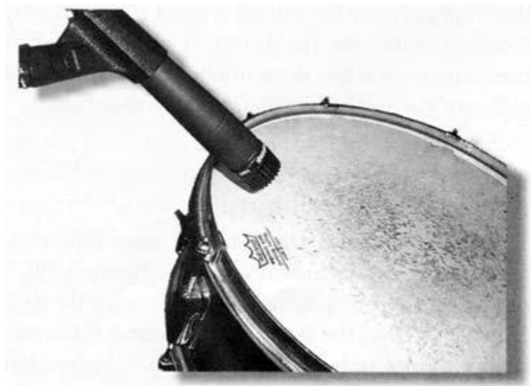
Εικόνα 1.2.2.3.1 Λήψη Snare με Close Miking τεχνική
