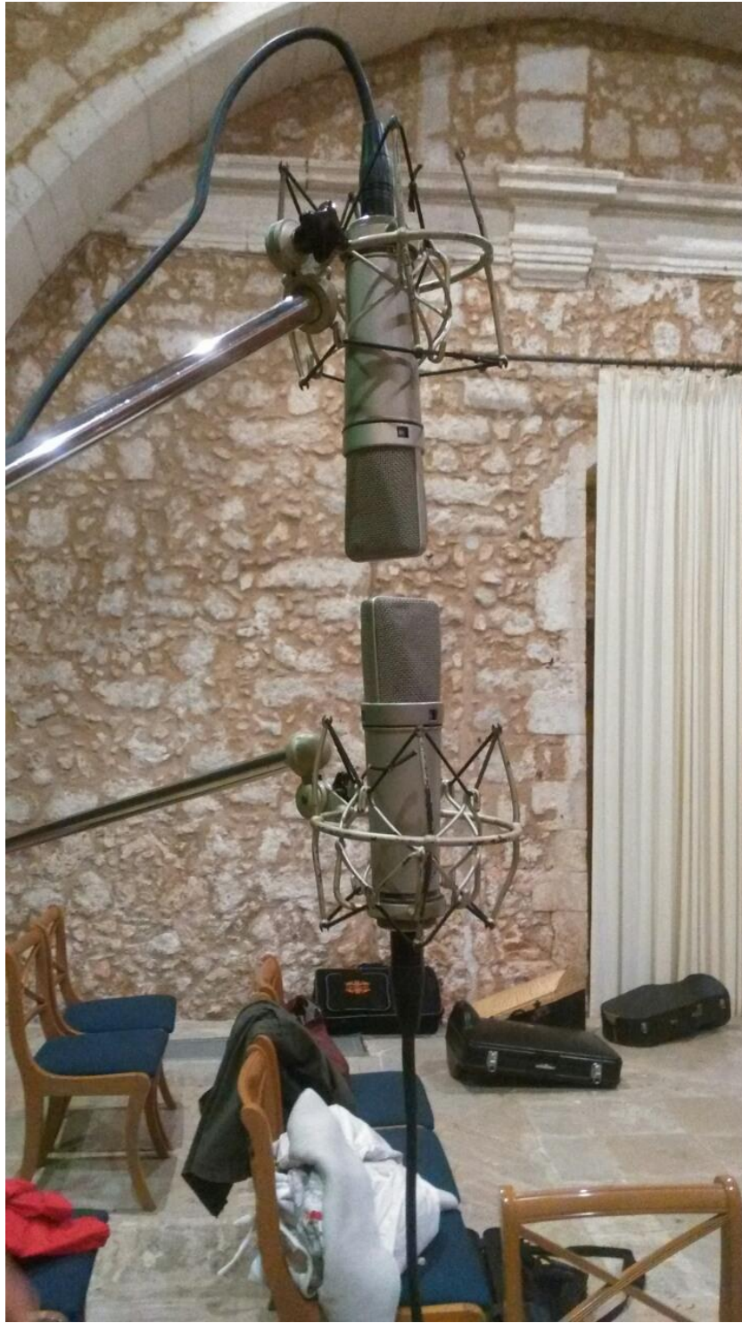
Εικόνα 2.6.2.2 Τοποθέτηση μικροφώνων με MS – Stereo
