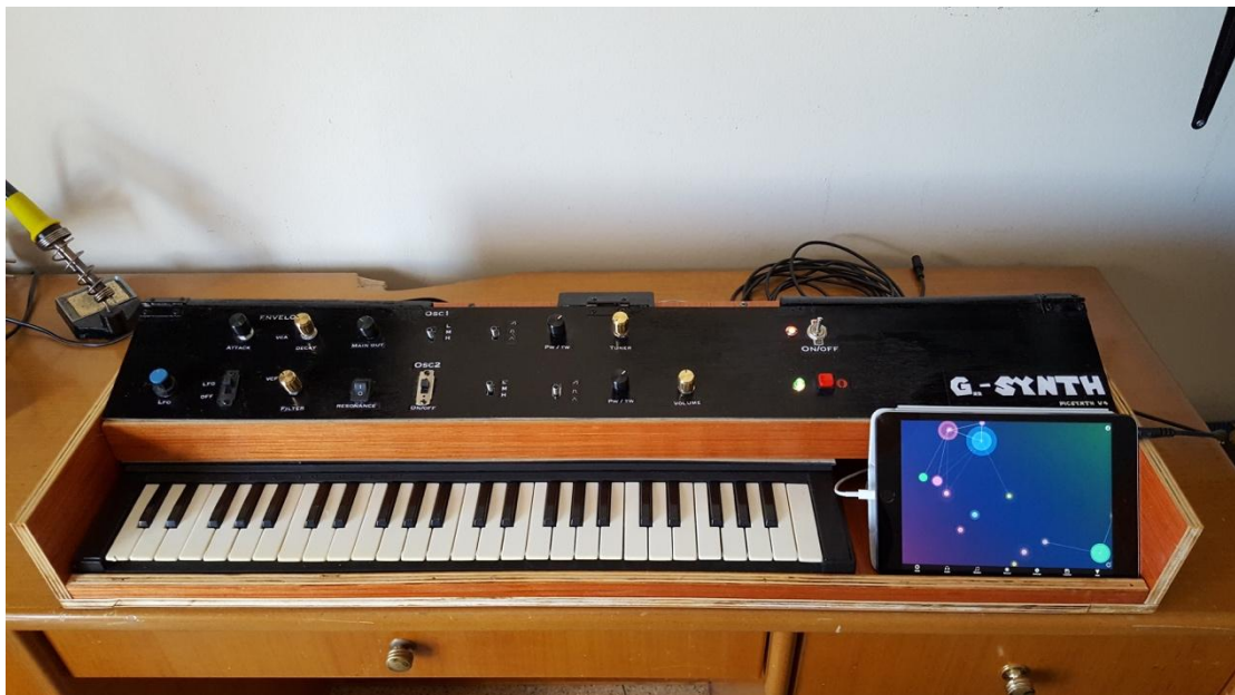
Εικόνα 4.2.18 Η ολοκληρωμένη πλέον κατασκευή του PICsynth συνδεδεμένο στην πρίζα και με το tablet συνδεδεμένο στον φορτιστή του synth.
