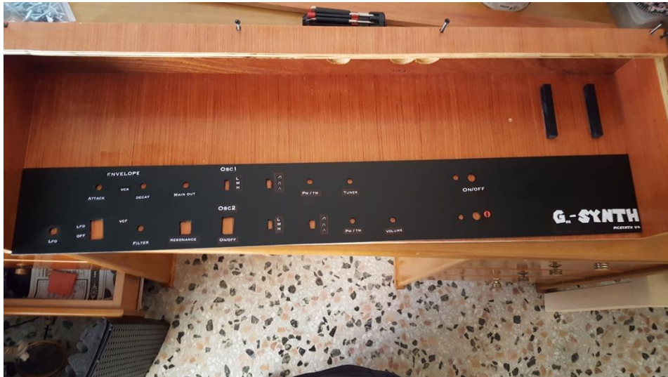
Εικόνα 4.2.15 Το κουτί πριν την τοποθέτηση των κυκλωμάτων και του πλήκτρου.
