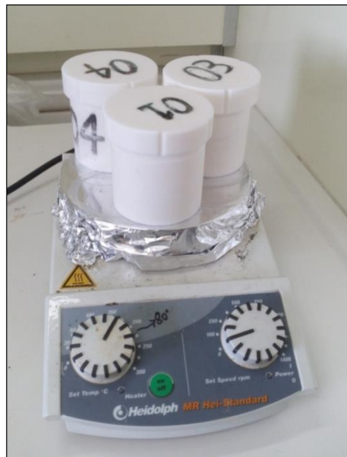
Εικόνα 11. Θερμαντική πλάκα και ειδικά κατασκευασμένες οβίδες από TEFLON
