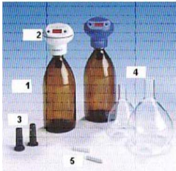
Εικόνα17 Ειδικός εξοπλισμός για την μέτρηση του BOD. Μπουκάλια (1), κεφαλές-ψηφιακοί αισθητήρες (2), θήκες από καουτσούκ (3),ογκομετρική φιάλη υπερχειλίσης όγκου 428 ml (4) μαγνητικές ράβδοι ανάδευσης (5). (Κυρίου, 2010)
