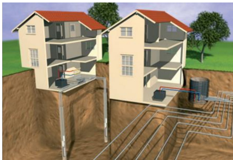
Εικ. 2.21 Οριζόντιοι και κάθετοι γεωεναλλάκτες (Πηγή https://thermansipress.gr )
