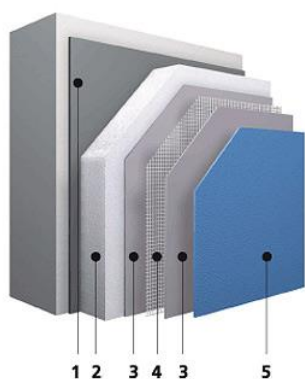
Εικ. 5.2 Σύστημα εξωτερικής θερμομόνωσης (πηγή http://www.stohellas.gr/ )
