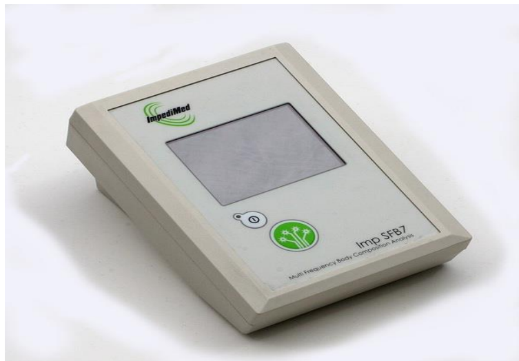
Εικόνα 2.3. Η συσκευή BIS που χρησιμοποιήσαμε στην έρευνά μας «Imp SFB7» της ImpediMed με ανάλυση 256 συχνοτήτων, 2005
