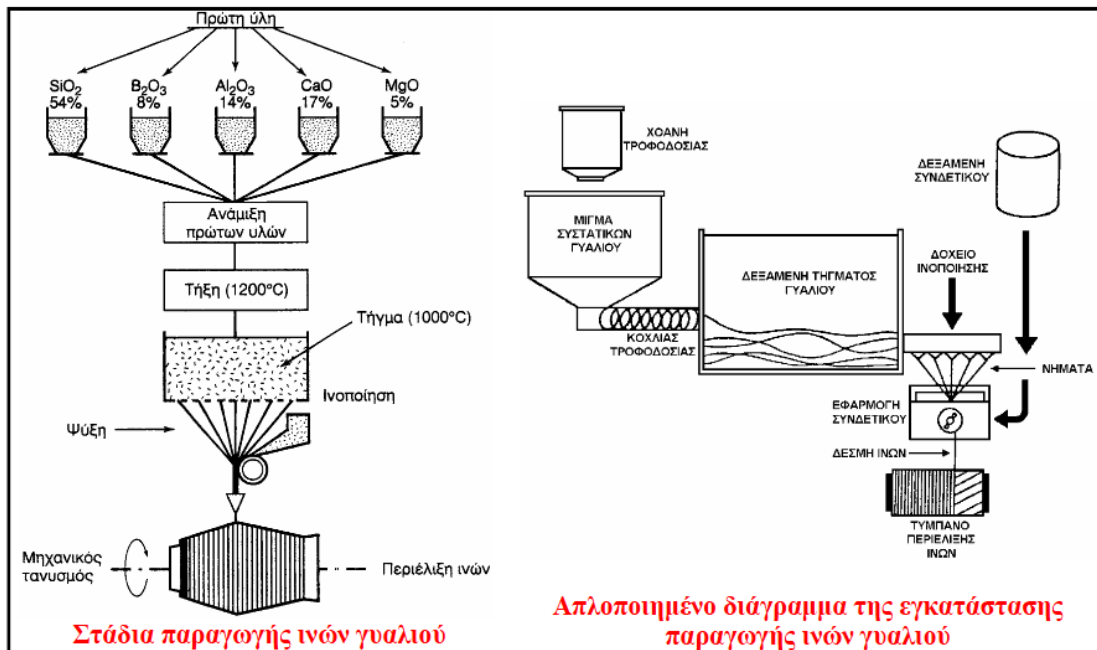
Σχήμα 4.1: Παραγωγή ενισχυτικών ινών γυαλιού {6}.
