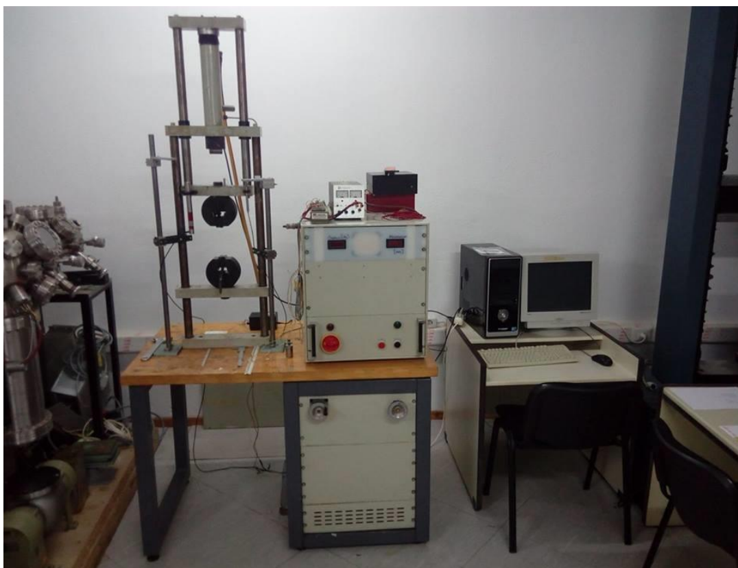
Σχήμα 5.12: (α) Διάταξη εφελκυσμού (β) Διάταξη κάμψης τριών σημείων
