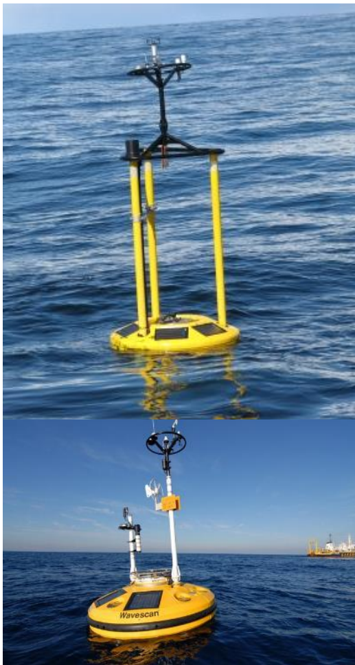
Εικόνα 1-3. Τύποι πλωτών παρατηρητήριων. Πάνω: Παράκτιο. Κάτω: Ανοιχτής θάλασσας, Δεξιά: Αγκυροβόλιο.
