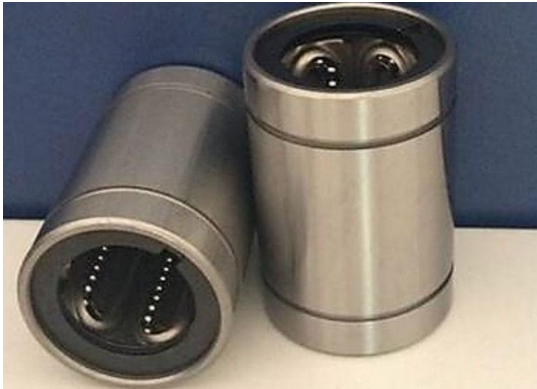
Σχήμα 43: Γραμμικά ρουλεμάν που χρησιμοποιήθηκαν.
