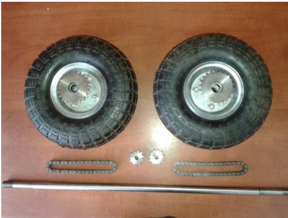
Οι ρόδες με τα ενσωματωμένα γρανάζια, οι αλυσίδες, τα γρανάζια κινητήρων, και ο άξονας στήριξης
