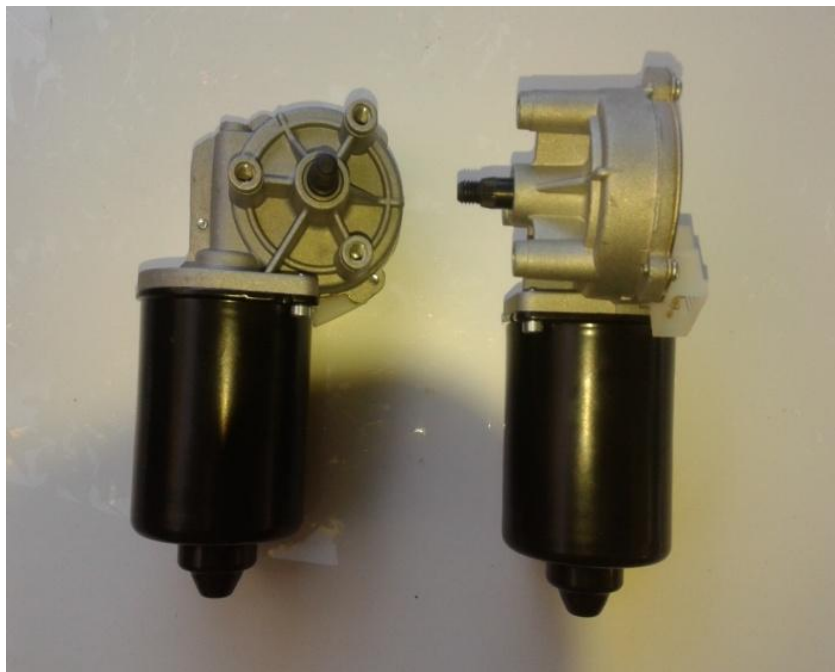
Οι δύο κινητήρες με ενσωματωμένο σύστημα μείωσης στροφών.
