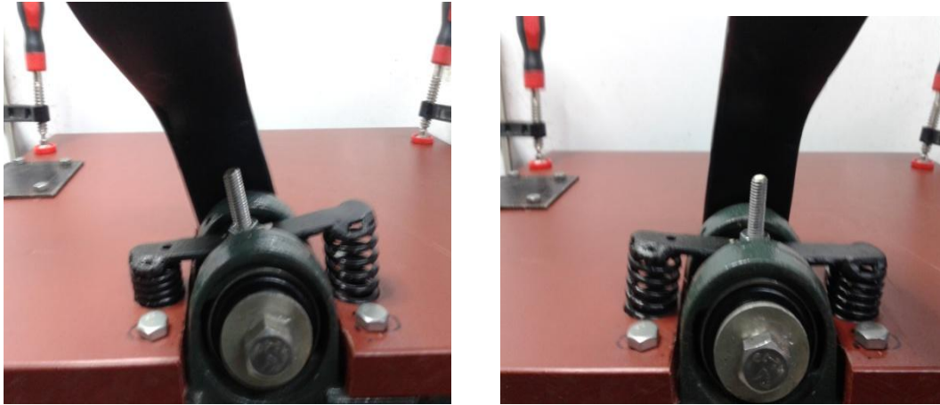
Δοκιμή μηχανισμού ελατηρίων σε κίνηση αριστερά –δεξιά.
