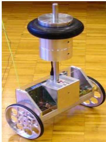
Πρωτότυπο δίτροχο όχημα αυτό-ισορρόπησης στηριζόμενο στο ανεστραμμένο εκκρεμές.
