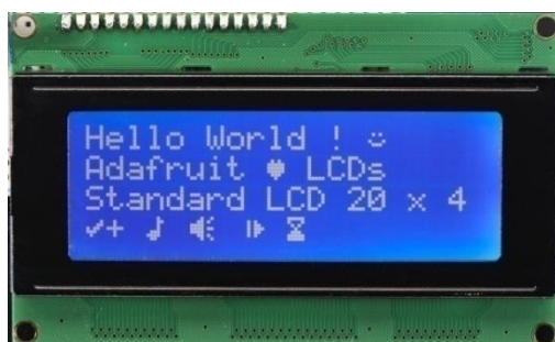
Οθόνη LCD 20X4 χαρακτήρων και το I2C interface
