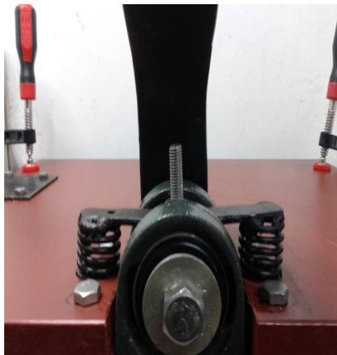
Ο μηχανισμός τιμονιού με τα ελατήρια επαναφοράς (Inkscape)
