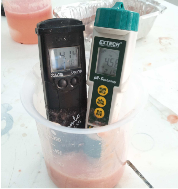
Εικόνα 4.28: Πεχάμετρο και αγωγιμόμετρο για τον προσδιορισμό του pH και της ηλεκτρικής αγωγιμότητας αντίστοιχα.
