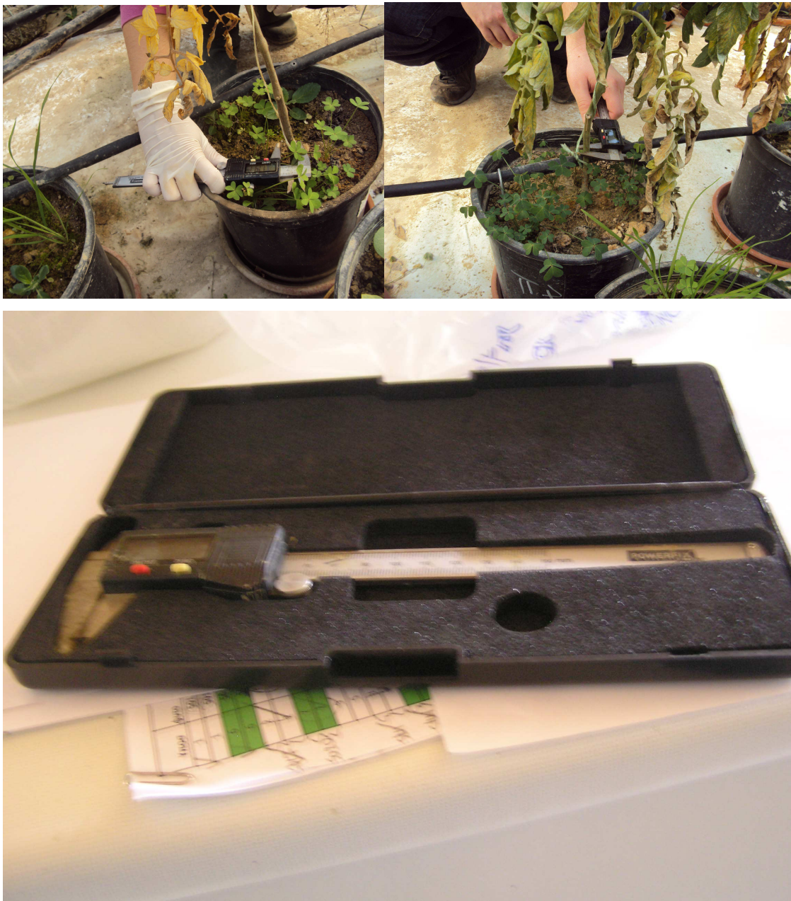
Εικόνα 4.20: Μέτρηση πάχους στελέχους φυτών τομάτας με παχύμετρο.
