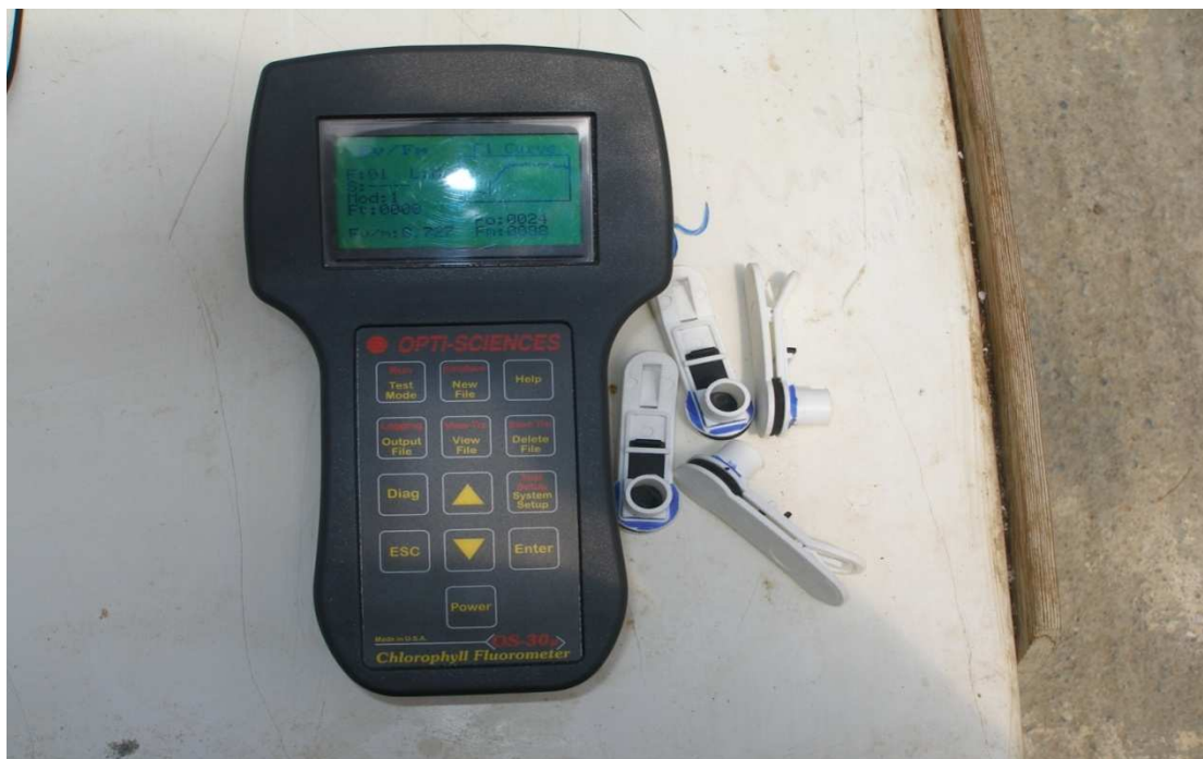
Εικόνα 4.22: Φθορίμετρο, opti-scences UK και τα ειδικά "μανταλάκια".
