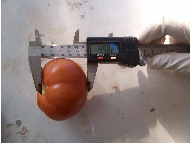
Εικόνα 4.30: Μέτρηση μήκους και πλάτους καρπού με την χρήση του παχύμετρου ακριβείας.
