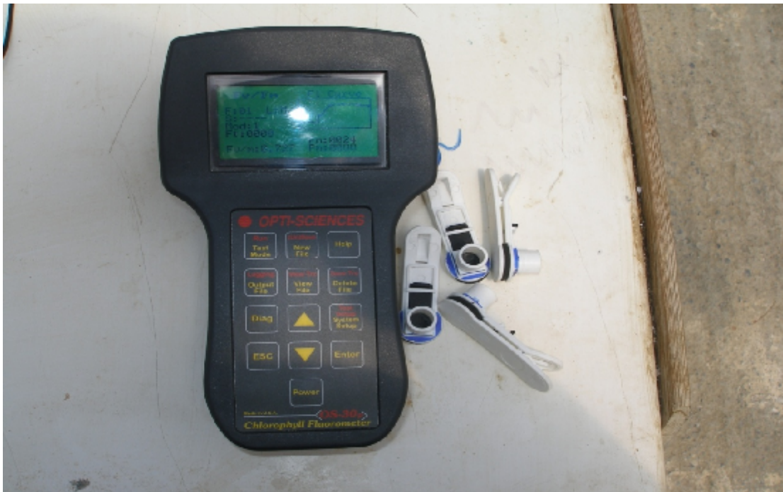
Εικόνα 4.22: Φθορίμετρο, opti-sciences UK και τα ειδικά "μανταλάκια".
