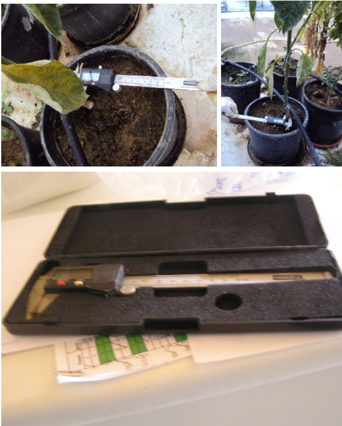
Εικόνα 4.21: Μέτρηση πάχους στελέχους φυτών πιπεριάς με παχύμετρο
