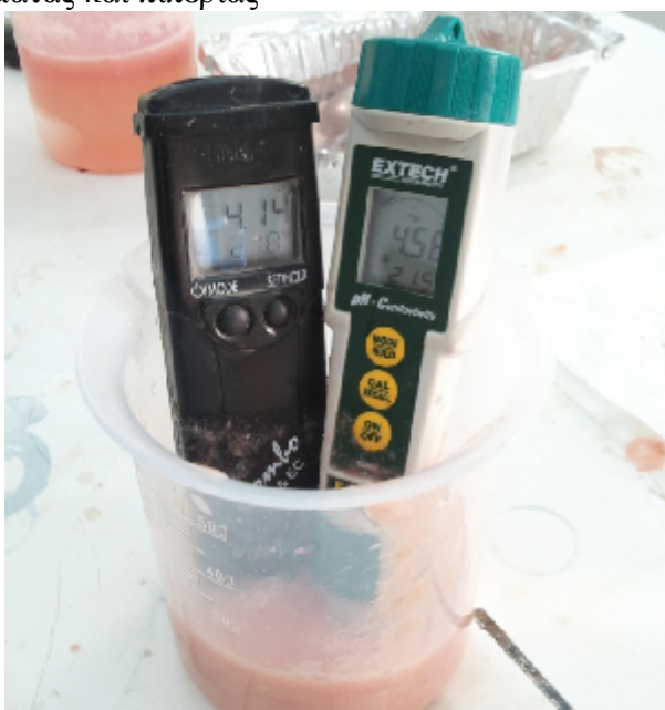
Εικόνα 4.28: Πεχάμετρο και αγωγιμόμετρο για τον προσδιορισμό του pH και της ηλεκτρικής αγωγιμότητας αντίστοιχα τομάτας και πιπεριάς
