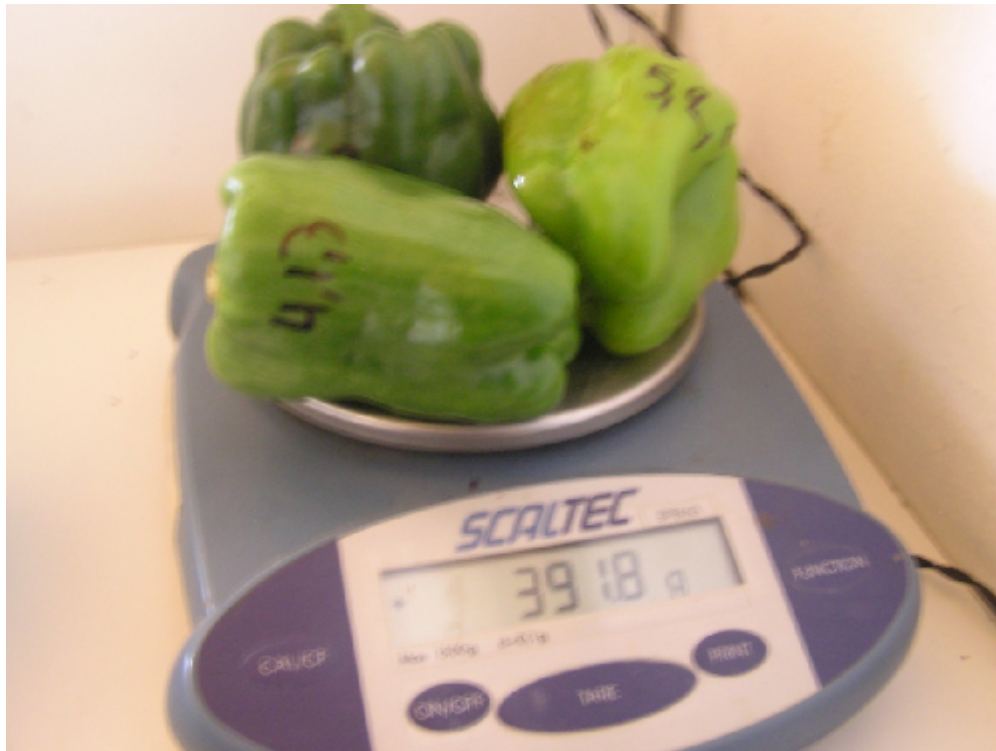
Εικόνα 4.24: Ζυγαριά για μέτρηση νωπού και ξηρού βάρους
