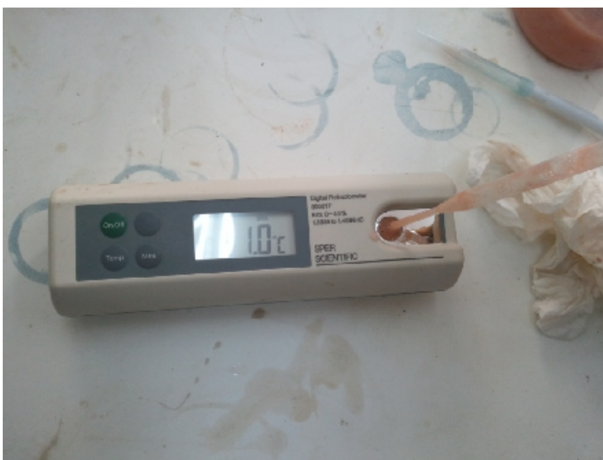
Εικόνα 4.27: Διαθλασίμετρο για τον προσδιορισμό των ολικών διαλυτών στερεών (TSS) τομάτας και πιπεριάς
