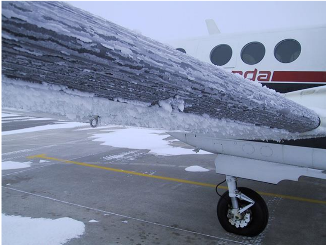
Αεροπλάνο που χρήζει υπηρεσίας Anti Ice System
