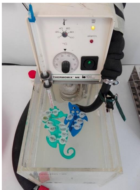
Εικόνα 9: Υδατόλουτρο επώασης των δειγμάτων στους 65°C.
