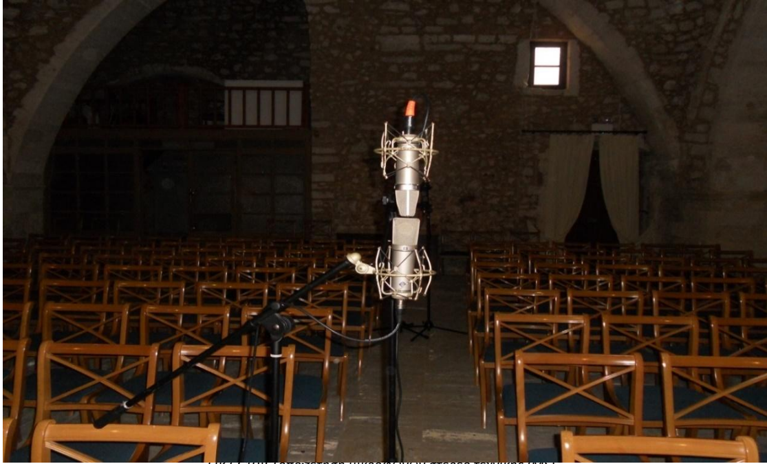
Εικ.(2.10): Τοποθέτηση μικροφώνων στέρεο τεχνικής (MS)
