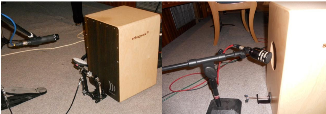
Εικ.(2.19): Τοποθέτηση μικροφώνων στο καχόν, εμπρός-πίσω
