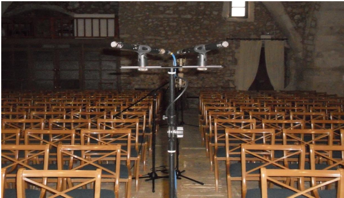
Εικ.(2.11): Τοποθέτηση μικροφώνων στέρεο τεχνικής (ORTF)
