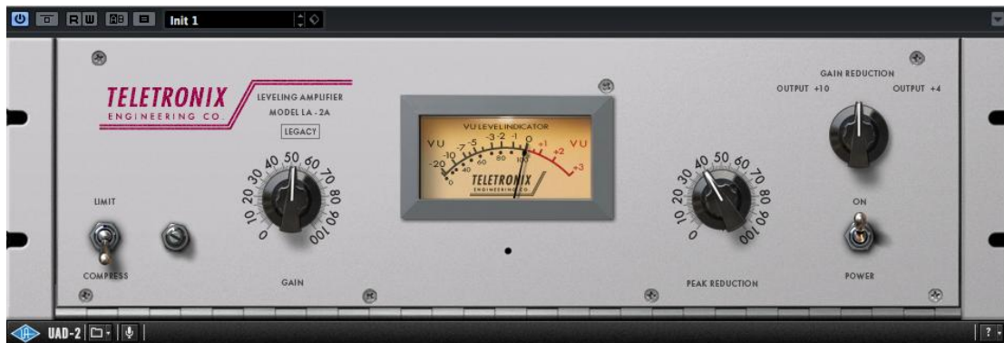
Εικ.(3.10): Teletronix LA-2A, προσομοίωση (plug-in) της UAD, στην φωνή
