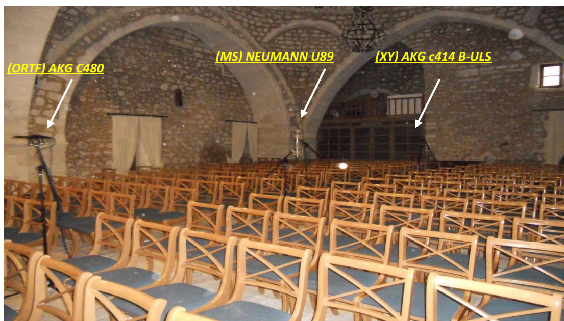
Εικ.(2.12): Τοποθέτηση μικροφώνων στέρεο τεχνικών στο χώρο
