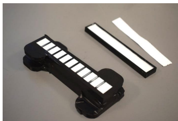
Εικόνα 31 Τα αποτελέσματα μετά την χύτευση της σιλικόνης στο καλούπι
