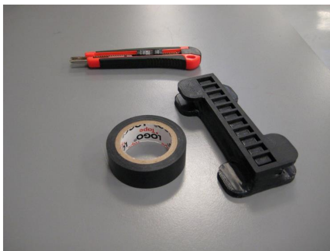
Εικόνα 28 Διαδικασία μόνωσης των δύο τμημάτων του καλουπιού
