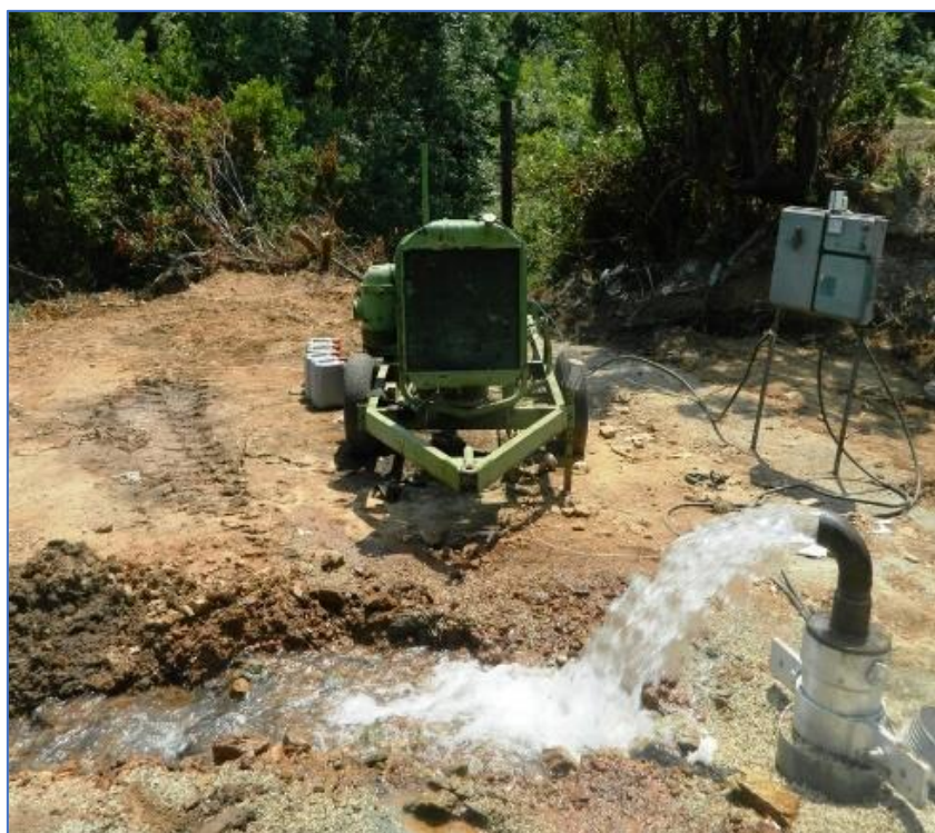
Εικόνα 3.1: Εξόρυξη του νερού από τη γεώτρηση
