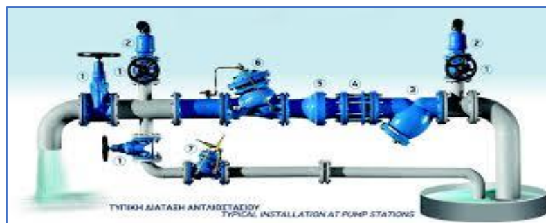
Εικόνα 3.4: Τυπική διάταξη αντλιοστασίου με παροχή γεώτρησης
