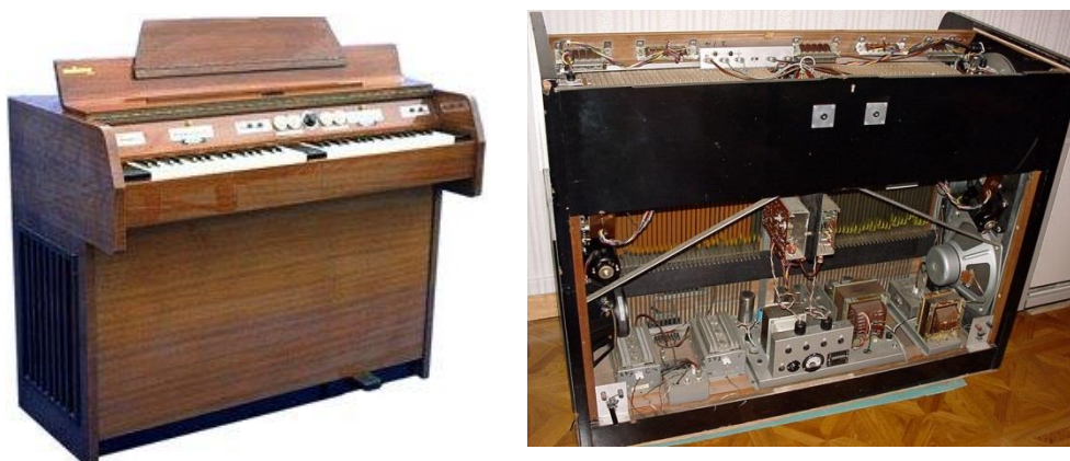
Έικ. 3.2: Το Mellotron MK I και η εσωτερική του κατασκευή με τις μαγνητοταινίες
