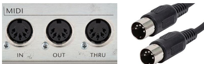
Εικ. 3.1: Οι τυπικές συνδέσεις MIDI ενός synthesizer και το πενταπολικό καλώδιο
