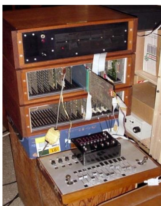
Έικ. 3.3: Synclavier 1977 χωρίς πληκτρολόγιο που προστέθηκε σε επόμενα μοντέλα
