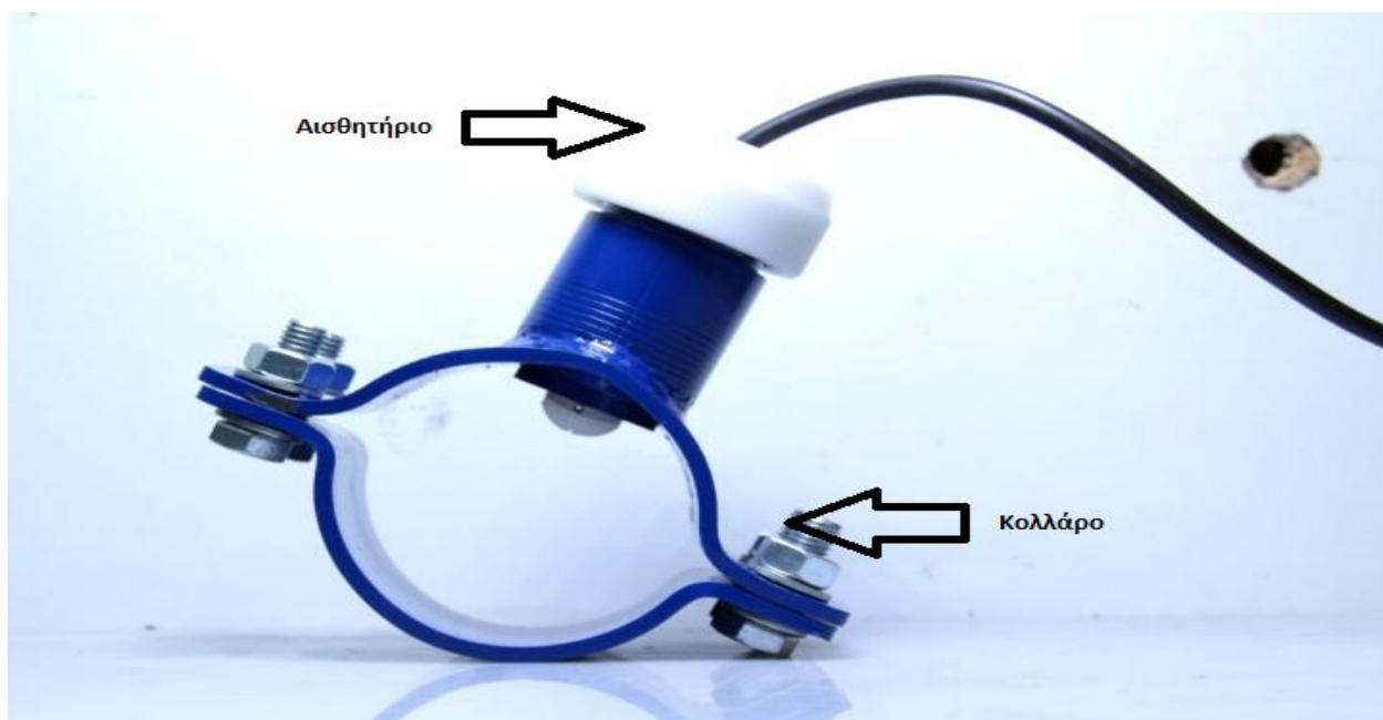
Εικ. 3.25: Το αισθητήριο που τοποθετείται πάνω στον αγωγό
