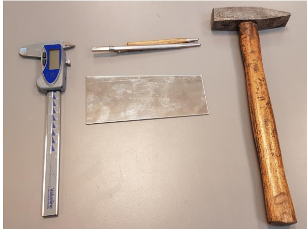
Εικόνα 6.10: Εργαλεία που χρησιμοποιήθηκαν για την διαμόρφωση των οπών στα σημεία που πρέπει.
