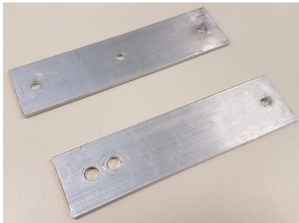
Εικόνα 6.19 Οι δύο διαφορετικοί τύποι των συνδέσμων του συστήματος ανάρτησης για τη συγκράτηση του προσθετικού πήχη επάνω από τον αγκώνα.
