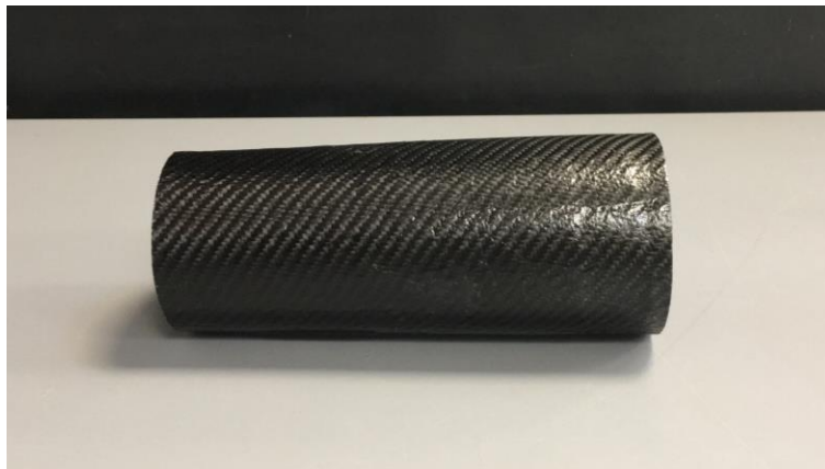
Εικόνα 6.6: το εξωτερικό περίβλημα του προσθετικού πήχη μετά από κοπή στις απαιτούμενες διαστάσεις και επικάλυψη με ακρυλικό βερνίκι.
