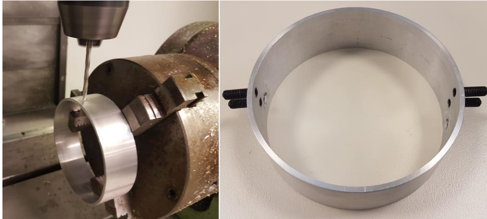
Εικόνα 6.18: Δημιουργία σπών στο δακτύλιο σύνδεσης του συστήματος ανάρτησης αριστερά και το τελικό εξάρτημα με τους ακέφαλους κοχλίες Allen στα δεξιά.
