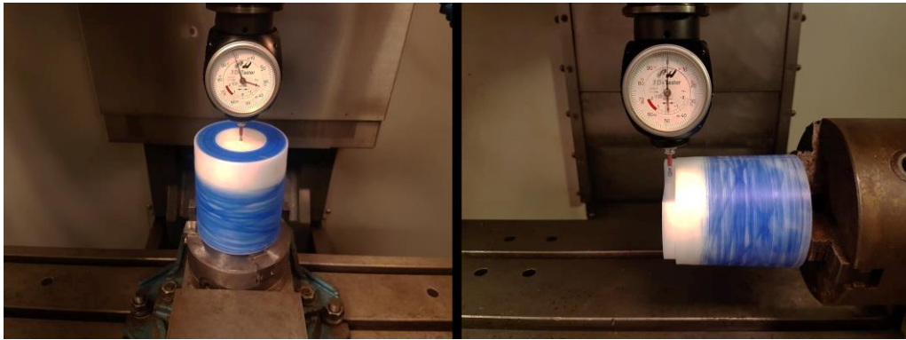
Εικόνα 6.12: Μηδενισμός αντικειμένου στη φρέζα CNC για την πρώτη, αλλά και για τη δεύτερη συγκράτηση στο διαιρέτη.
