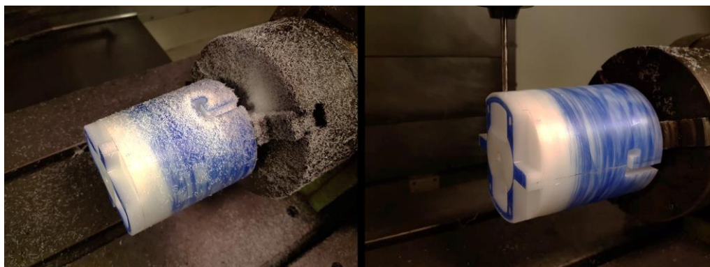
Εικόνα 6.14: Κατεργασία πλαϊνής επιφάνειας του αντικειμένου για δημιουργία αυλακιού με κονδύλι \Phi 6 "Endmill" και δημιουργία τρύπας στην επιφάνεια που βρίσκεται 90^\circ από την προηγούμενη του αντικειμένου με \Phi 4 τρυπάνι.
