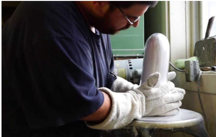
Εικόνα 2.9: Κατασκευή υποδοχής από θερμοπλαστικό πολυμερές με την βοήθεια καλουπιού από γύψο.
