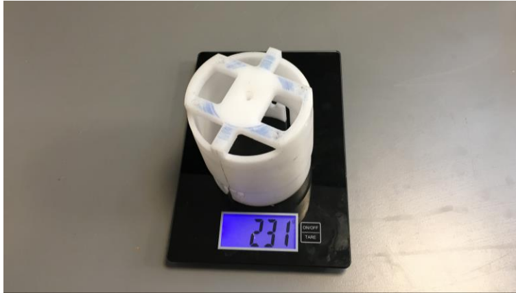
Εικόνα 6.16: Αποτέλεσμα της κεντρικής βάσης μετά από τη σειρά κατεργασιών (όπως αυτή σχεδιάστηκε στην Εικόνα 4.3 επάνω σε ζυγαριά με μάζα στα 231gr.
