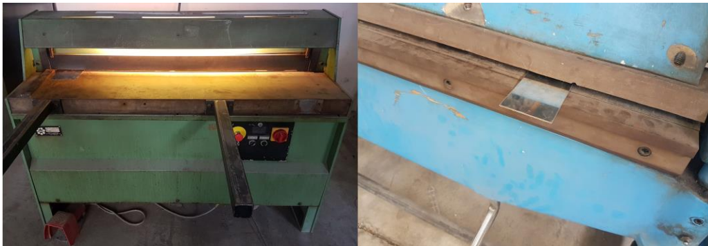
Εικόνα 6.9: Μηχανές που χρησιμοποιήθηκαν για την διαμόρφωση της λάμας. Αριστερά το ειδικό ψαλίδι για λαμαρίνες και δεξιά η στράντζα.
