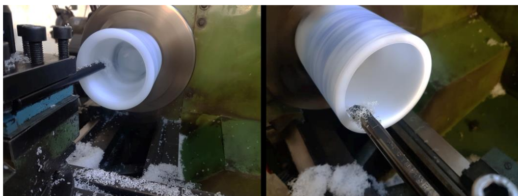
Εικόνα 6.15: Κατεργασία εσωτερικής επιφάνειας της κεντρικής βάσης με εσωτερική μανέλα σε συμβατικό τόρνο.
