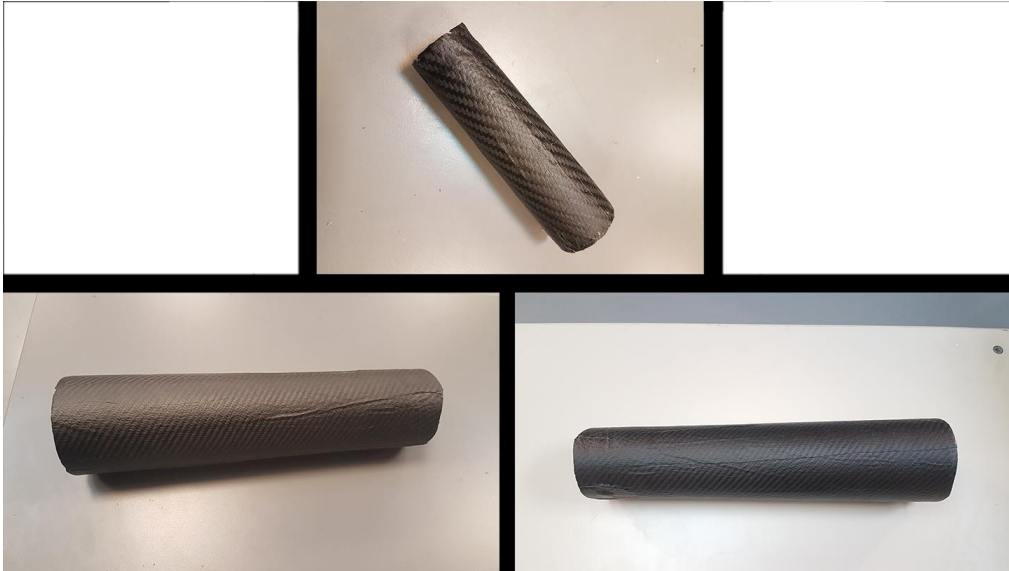
Εικόνα 6.5: Αποτελέσματα από τις 3 προσπάθειες κατασκευής του περιβλήματος. Επάνω βρίσκεται το μικρό – πειραματικό που κατασκευάζεται. Κάτω αριστερά βρίσκεται το πρώτο μεγάλο περίβλημα και κάτω δεξιά η τρίτη και τελευταία προσπάθεια.
