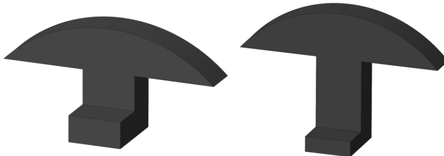
Εικόνα 4.4: Τρισδιάστατη μοντελοποίηση των δύο σφηνών, αριστερά η μικρή και δεξιά η μεγάλη.
