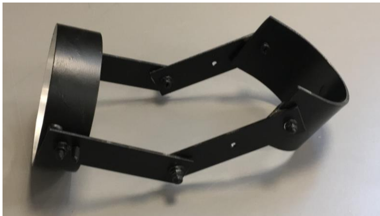
Εικόνα 6.17: Ολοκληρωμένη κατασκευή του συστήματος ανάρτησης του προσθετικού πήχη με επικάλυψη από σπρέι πλαστικοποίησης.
