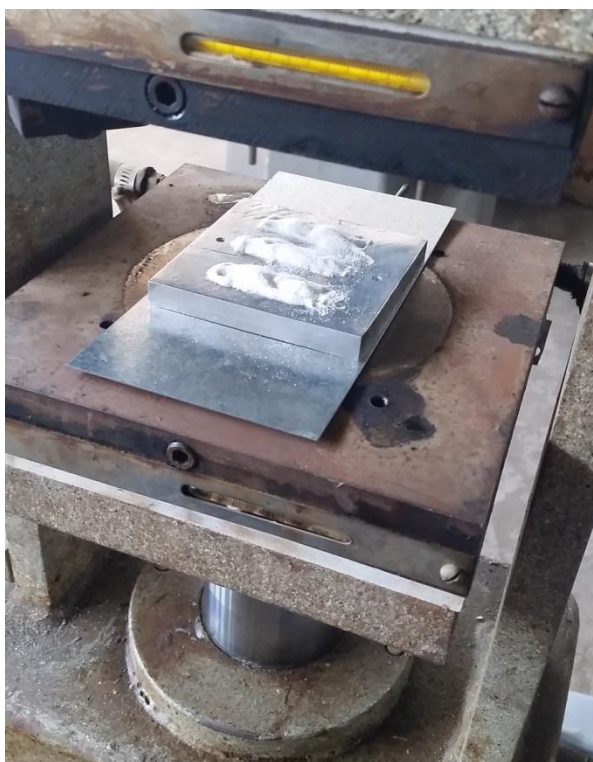
Εικόνα 5-14: Τοποθετείται η μήτρα με τη σκόνη ABS στην πρέσα.
