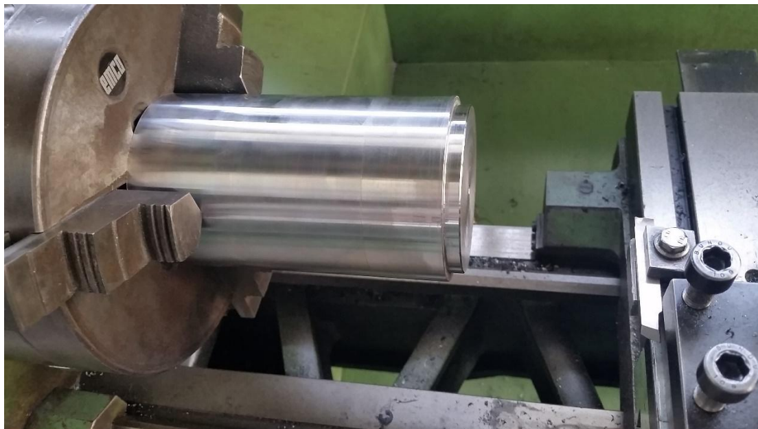
Εικόνα 5-5: Σύνδεσμος μορφοποιημένος με την εσοχή κατά την διάρκεια της κατασκευής του.
