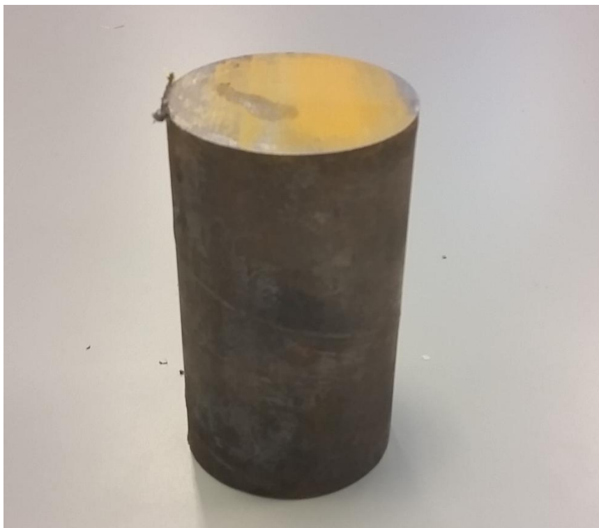
Εικόνα 5-2: Κύλινδρος χάλυβα για την κατασκευή συνδέσμου της χυτόπρεσας.
