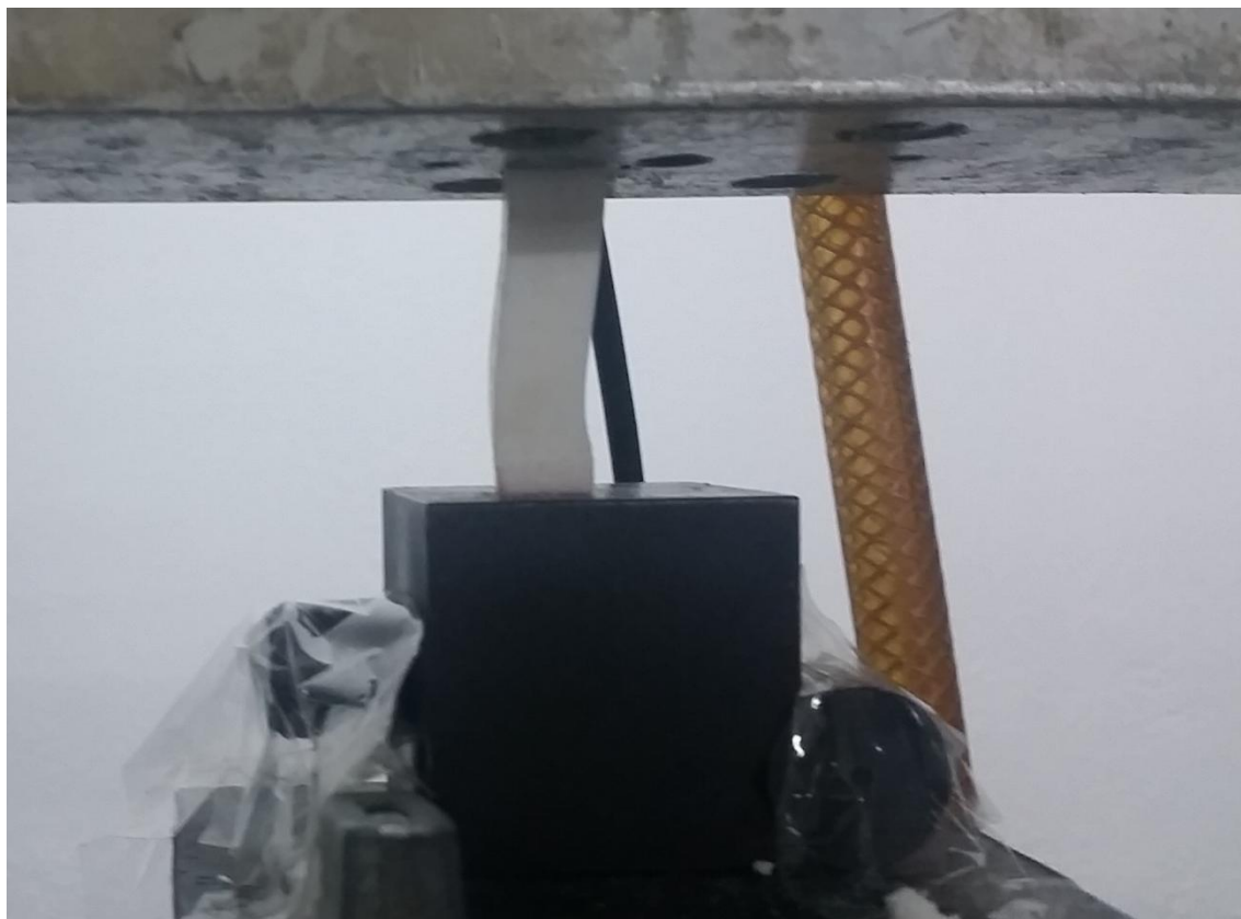
Εικόνα 5-30: Παραμόρφωση του δοκιμίου κατά τη διάρκεια της φόρτισής του, πριν αστοχήσει.
