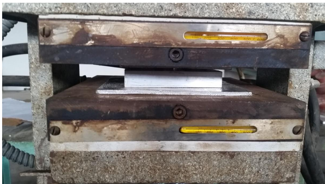
Εικόνα 5-16: Συμπύεση του ζεύγους εμβόλου- μήτρας με δύναμη 1ton και θερμοκρασία 200 °C.
