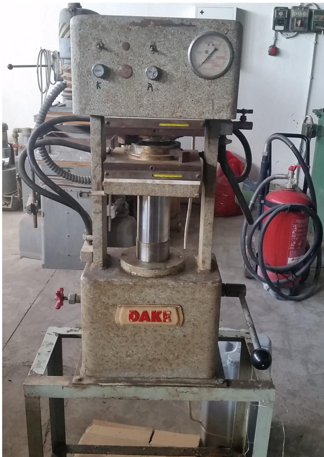
Εικόνα 5-9: Η πρέσα που χρησιμοποιήθηκε για την παρασκευή των δοκιμίων.
