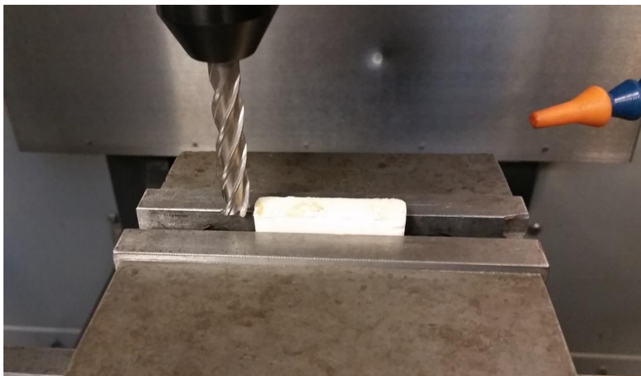
Εικόνα 5-24: Εργαλείο αναφοράς για το μηδενισμό του Z άξονα.
