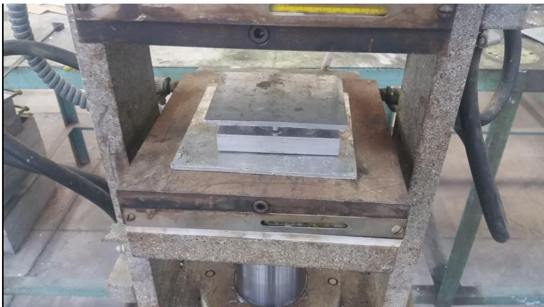
Εικόνα 5-15: Τοποθετείται το έμβολο πάνω στη μήτρα.
