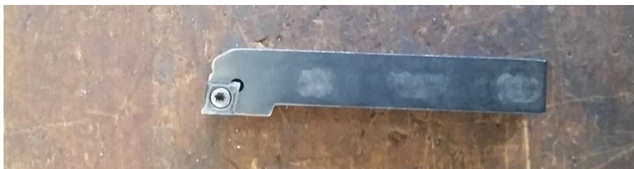
Εικόνα 5-4: Κοπτικό εργαλείο για τη διαμόρφωση του αρσενικού μέρους του συνδέσμου.
