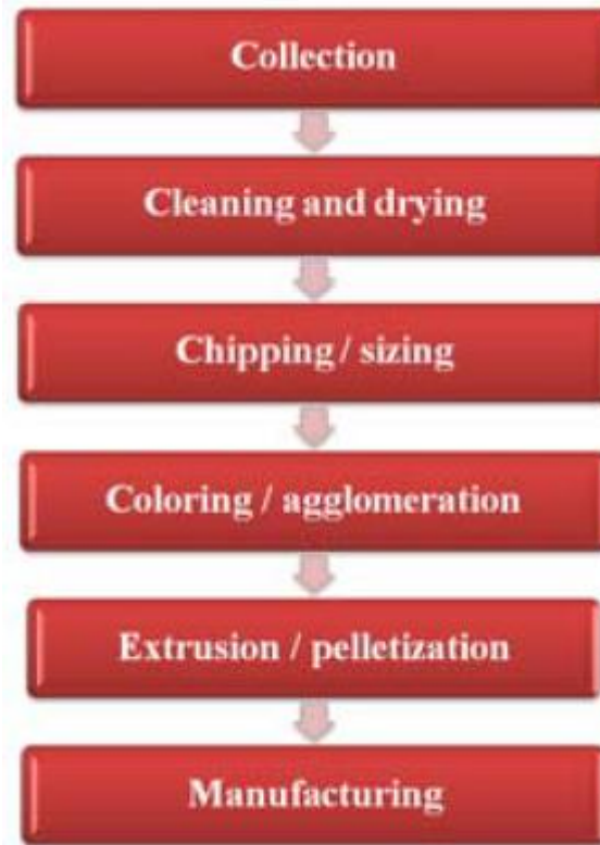
Εικόνα 4-1: Στάδια μηχανικής ανακύκλωσης[6]
