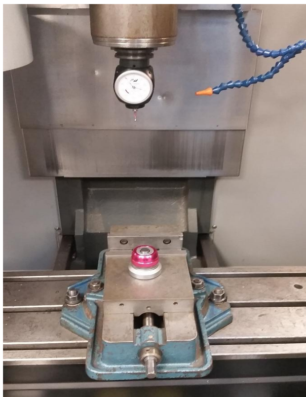
Εικόνα 5-20: Τοποθέτηση Magnetic Dial Setter και 3D Taster στην τράπεζα της φρέζας για τον μηδενισμό.
