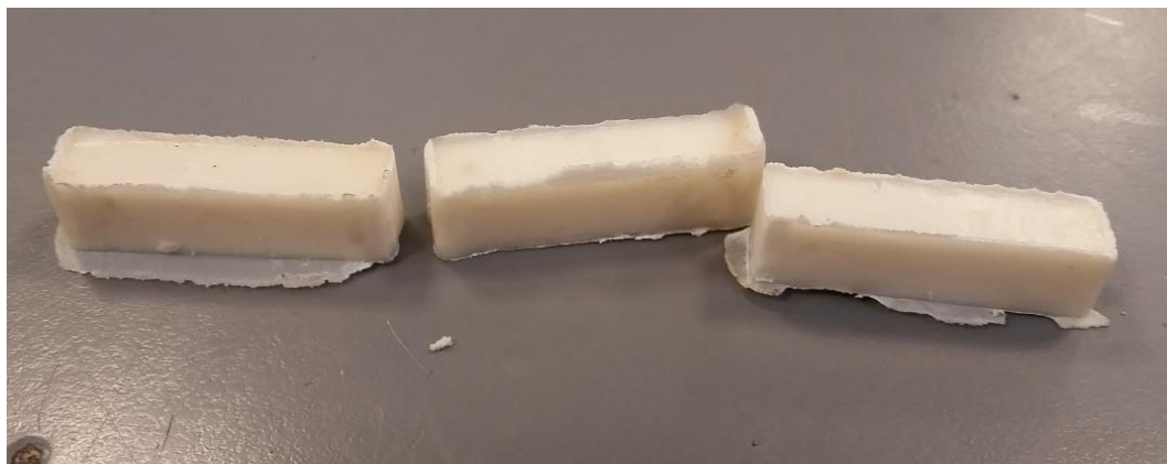
Εικόνα 5-17: Τα δοκίμια όπως βγήκαν από το καλούπι, πριν καθαριστούν.
