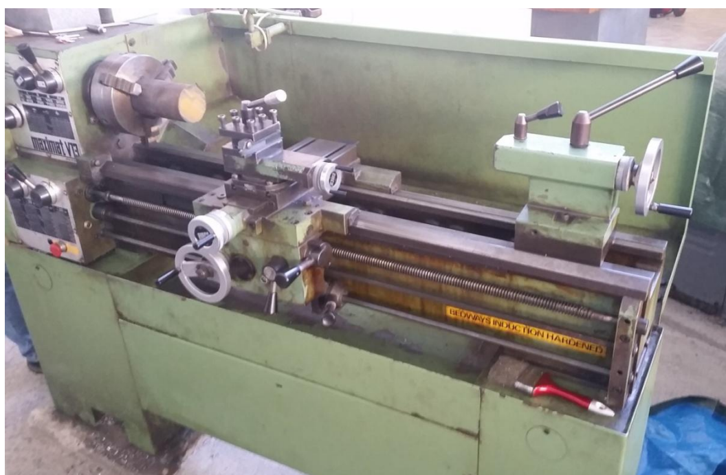
Εικόνα 5-3: ο Τόρνος που χρησιμοποιήθηκε για τη μορφοποίηση του συνδέσμου.
