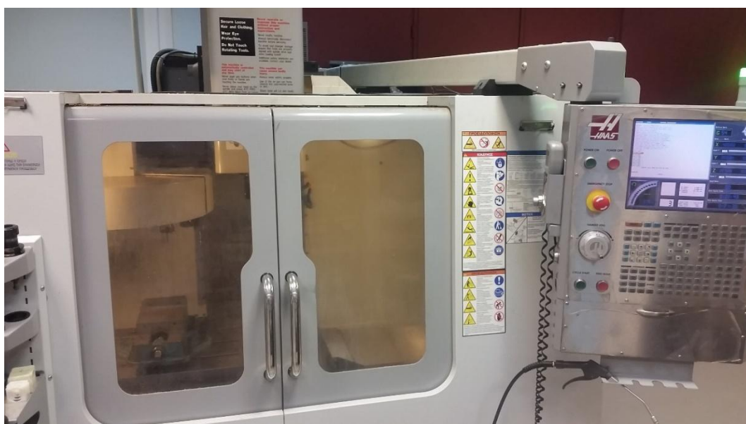
Εικόνα 5-19: CNC φρέζα της Haas. Φαίνεται και ο πίνακας ελέγχου.
