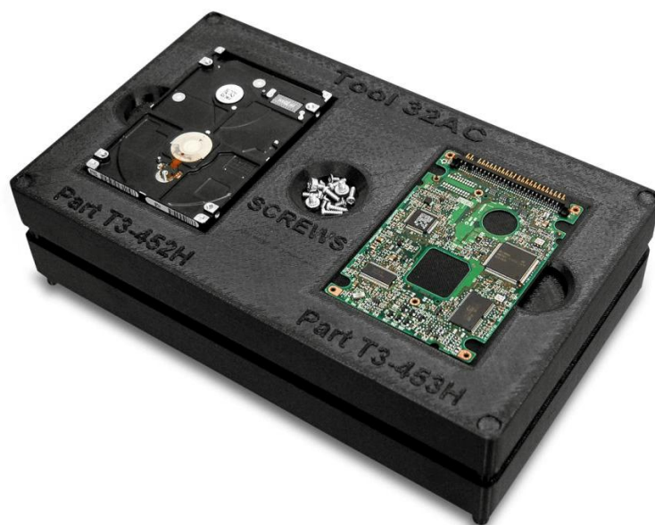
Εικόνα 3-4: Συσσκευή σκληρού δίσκου που εκτυπώθηκε 3D με υλικό ABS-ESD7.
