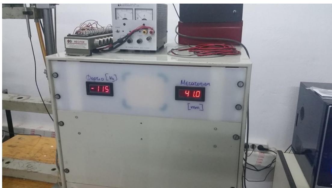
Εικόνα 5-28: Ένδειξη μετρήσεων φορτίου και μετατόπισης κατά την έναρξη της δοκιμής θλίψης.
