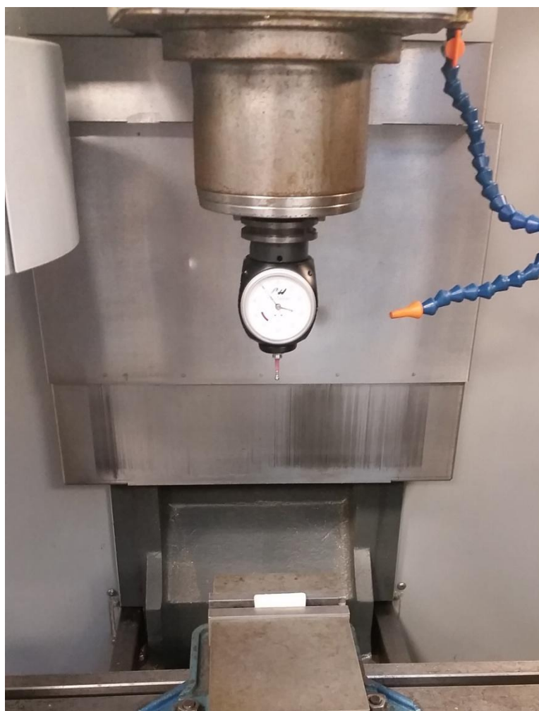
Εικόνα 5-18: Μηδενισμός τεμαχίου στη φρέζα CNC.
