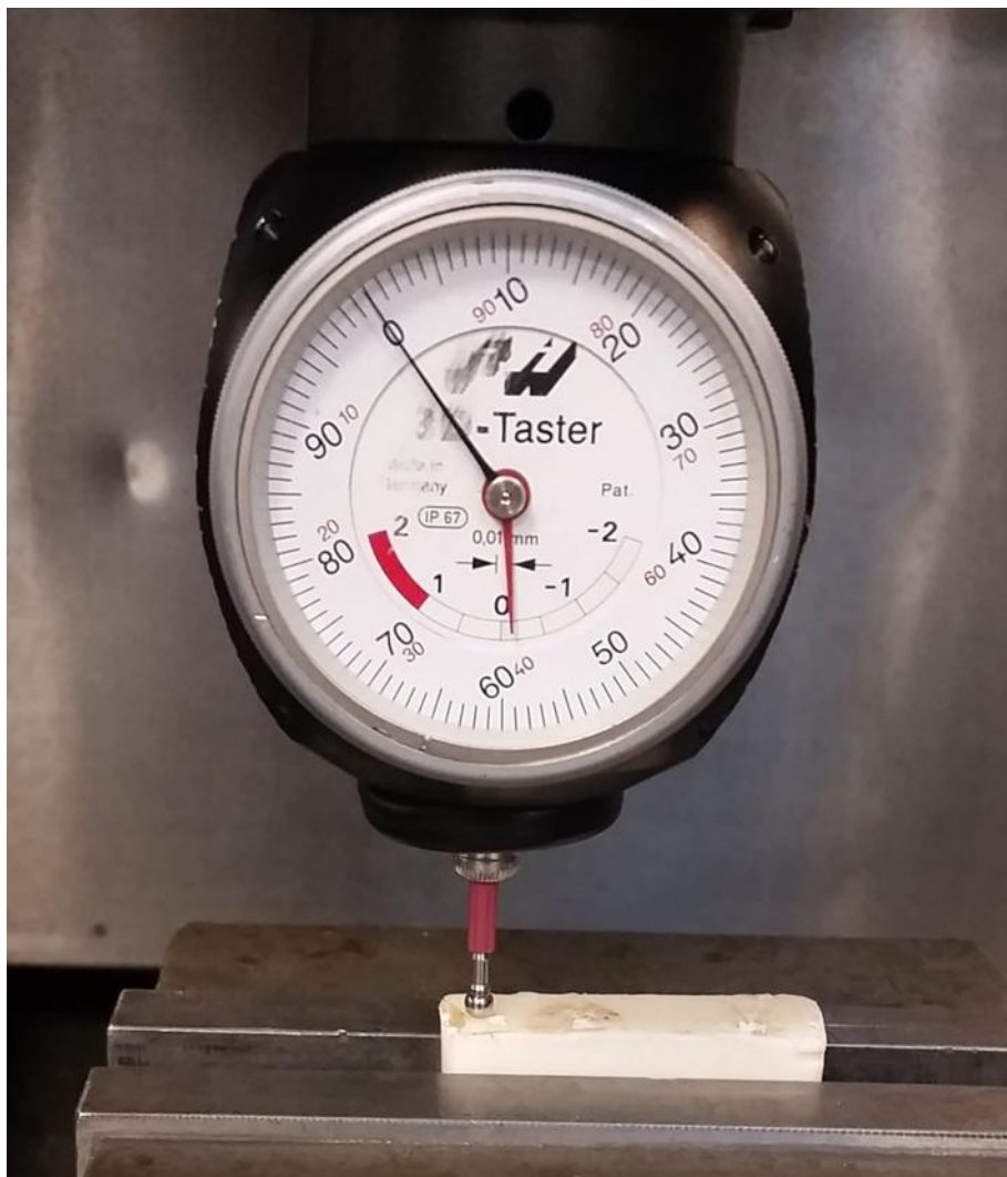
Εικόνα 5-23: Μηδενισμός κομματιού στον άξονα X,Y.
