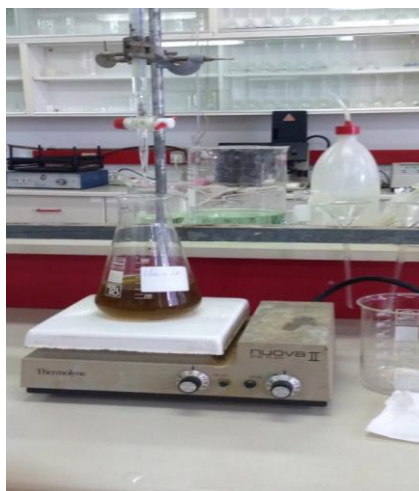
Εικόνα 5: Προσδιορισμός οργανικής ουσίας όταν το χρώμα διαμορφώθηκε σε πράσινο.
