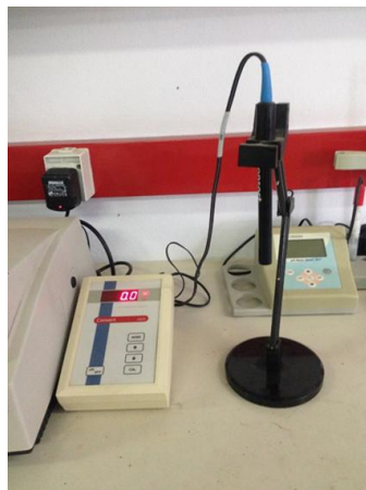
Εικόνα 7: Ηλεκτρικό αγωγιμόμετρο για την μέτρηση της ηλεκτρικής αγωγιμότητας.
