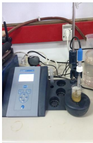
Εικόνα 6: Πεχάμετρο για την μέτρηση του pH.
