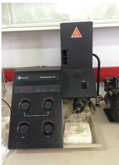
Εικόνα 8: Φλογωφωτόμετρο για τον προσδιορισμό του αφομοιώσιμου καλίου.
