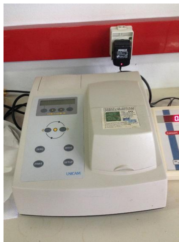
Εικόνα 10: Φασματοφωτόμετρο για τον προσδιορισμό του αφομοιώσιμου φωσφόρου.
