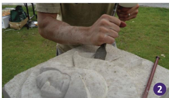
Εικόνα 2.5: Η διαδικασία εξευγενισμού με παραδοσιακά εργαλεία, όπως συνδυασμός οδοντωτής σμίλης - στρογγυλό σφυρί (1) και συνδυασμός επίπεδης σμίλης - στρογγυλό σφυρί (2).
