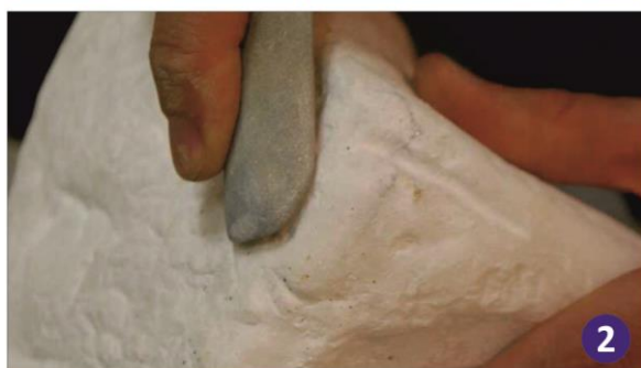
Εικόνα 3.13: Διαφόρων ειδών λίμες (1) και ο τρόπος κατεργασίας με λίθο λείανσης (2).
