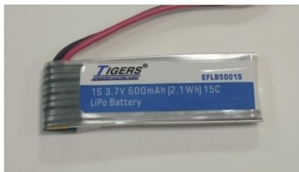
Εικόνα 9.11: Η μπαταρία Tigers 600 mA ιόντων λιθίου πολυμερούς.
