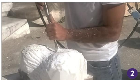
Εικόνα 2.6: Η διαδικασία εξευγενισμού με σύγχρονα εργαλεία, και στις δύο περιπτώσεις ο γλύπτης χρησιμοποιεί την οδοντωτή σμίλη σε συνδυασμό με το πνευματικό σφυρί (1), (2).
