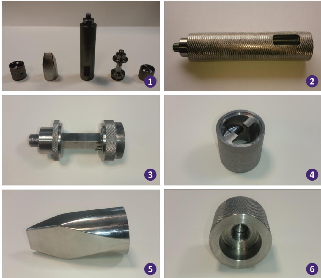
Εικόνα 7.8: Τα εξωτερικά τμήματα που απαρτίζουν τη βελτιστοποιημένη έκδοση του έξυπνου εργαλείου (1), το πίσω τμήμα (2), το εμπρόσθιο τμήμα (3), τα καπάκια του εμπρόσθιου τμήματος (4), η εναλλάξιμη σμίλη (5) και το οπίσθιο τμήμα κρούσης (6).
