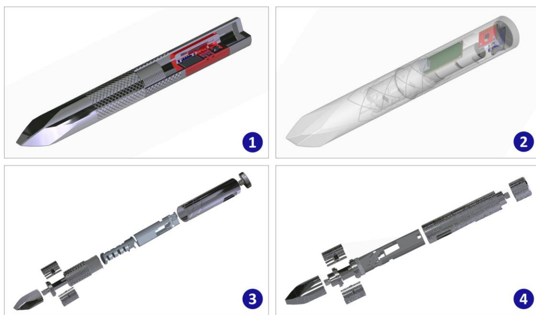
Εικόνα σύνοψης 1: Τα στάδια σχεδιασμού του έξυπνου εργαλείου κρουστικής λάξευσης, από την αρχική σχεδίαση του (1) έως και την τελική έκδοση (4), συμπεριλαμβανομένων και των δύο ενδιάμεσων σχεδιασμών (2) και (3).
