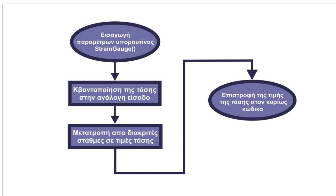
Εικόνα 10.2: Το διάγραμμα ροής της υπορουτίνας StrainGauge , για την επίτευξη μέτρησης των strain gauges .
