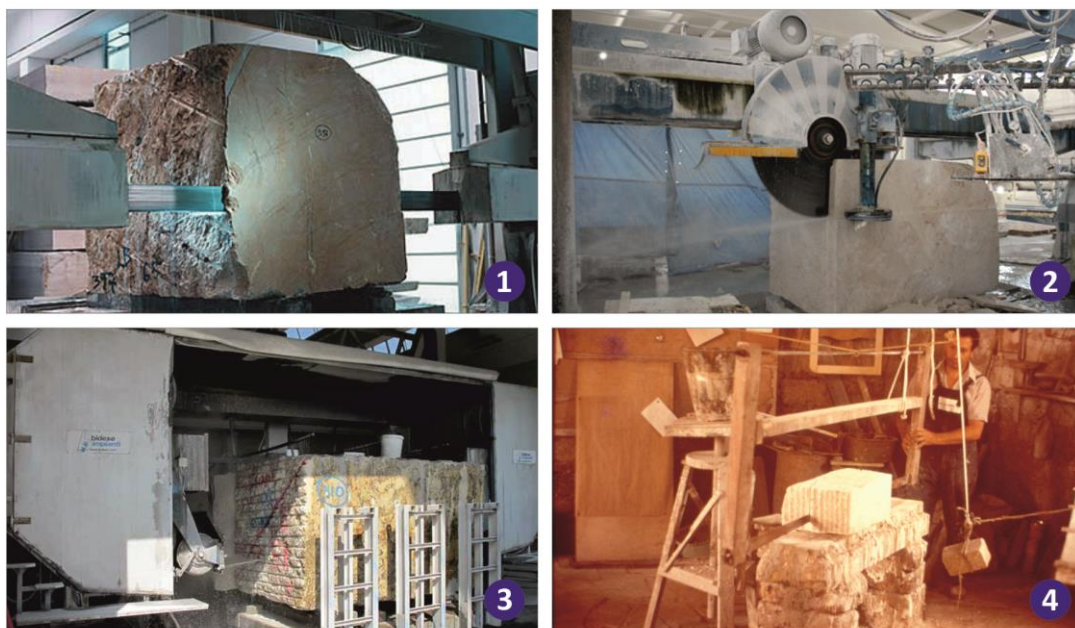
Εικόνα 3.2: Τα διάφορων τύπων πριόνια για λίθους, όπως ηλεκτροκίνητα με επιμήκεις λάμες (1) & (3), τα ηλεκτροκίνητα περιστροφικά με δίσκους κοπής (2) και τα επιμήκεις χειροκίνητα (4).
