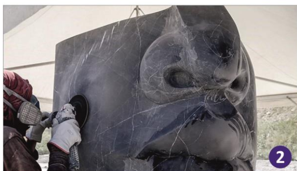
Εικόνα 2.8: Η διαδικασία λείανσης με σύγχρονα εργαλεία, όπως die grinders σε συνδυασμό με ειδικού τύπου λίμες (1) και angle grinders με δίσκους λείανσης (2).
