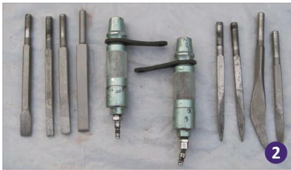
Εικόνα 3.24: Τα μεγέθη του πνευματικού σφυριού τύπου Cuturi (1) και οι διαφόρων τύπων σμίλες που δέχεται (2).
