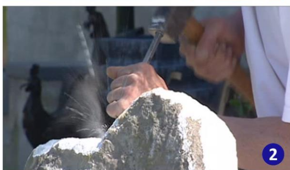
Εικόνα 2.3: Κατεργασία εκχόνδρισης με παραδοσιακά εργαλεία γλυπτικής, σμίλη σημείου σε συνδυασμό με στρογγυλό σφυρί (1) και σμίλη σημείου σε συνδυασμό με τετράγωνο (2).
