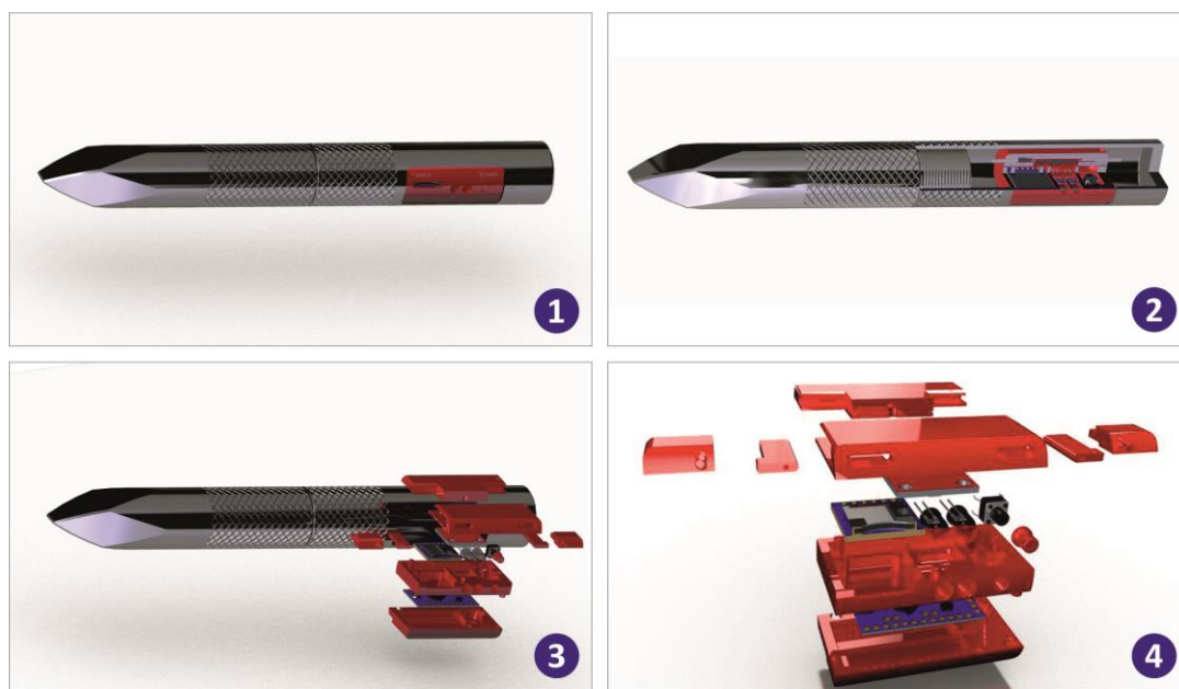
Εικόνα 7.1: Το τρισδιάστατο μοντέλο του αρχικού σχεδιασμού του έξυπνου εργαλείου, σε πλήρως συναρμολογημένη μορφή (1), σε τομή του οπίσθιου τμήματος (2), σε συναρμολογημένη μορφή με το τμήμα των ηλεκτρονικών διατάξεων σε ανεπτυγμένη μορφή (3) και το τμήμα των ηλεκτρονικών διατάξεων μόνο του σε ανεπτυγμένη μορφή (4).
