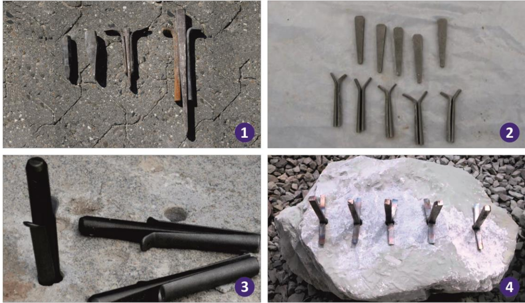
Εικόνα 3.4: Οι διάφοροι τύποι μεταλλικών σφηνών (1), το κυρίως σώμα και τα φτερά τους (2), η τοποθέτησή τους στις οπές του λίθου (3) και η βέλτιστη διάταξή τους στο λίθο (4).
