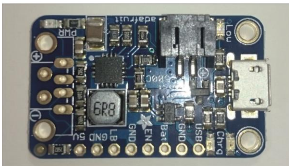
Εικόνα 9.10: Η μονάδα κεντρικής τροφοδοσίας, PowerBoost500C.
