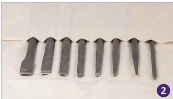
Εικόνα 3.11: Διάφορες διαστάσεις της επίπεδης σμίλης και μια σμίλη σημείου με επικάλυψη καρβιδίου.
