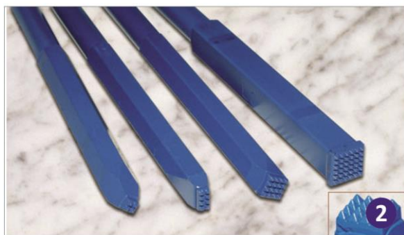
Εικόνα 3.25: Οι ειδικού τύπου σμίλες (1) και διάφορα μεγέθη της σμίλης πολλών σημείων (2).
