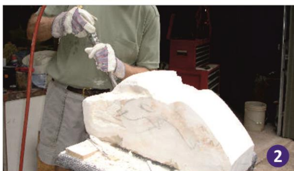
Εικόνα 2.4: Οι διαδικασίες εκχόνδρισης με σύγχρονα εργαλεία, όπως η κοπή περιττών κομματιών με angle grinder (1) και η σμίλευση με συνδυασμό πνευματικού σφυριού – σμίλης σημείου (2).
