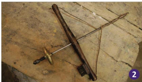
Εικόνα 3.12: Το φυγοκεντρικό τρυπάνι χειρός με σχοινί (1) και με ξύλινο πήχη (2).
