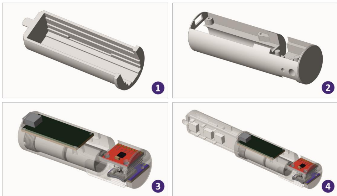
Εικόνα 7.3: Τα τρισδιάστατα μοντέλα των εσωτερικών τμημάτων συγκράτησης των ηλεκτρονικών διατάξεων, εμπρόσθιο (1) & οπίσθιο (2), οπίσθιο με τοποθετημένες τις ηλεκτρονικές διατάξεις (3) και η συνολική διάταξη (4).
