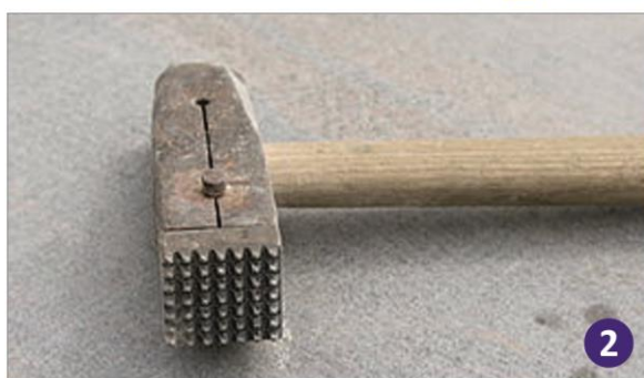
Εικόνα 3.5: Οι διάφοροι τύποι μεταλλικών σφυριών (1) και το σφυρί φινιρίσματος bush hammer (2).
