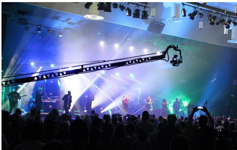
Εικ. 1.28: Χρήση γερανού κάμερας (crane/jib) για τη βιντεοσκόπηση συναυλίας
