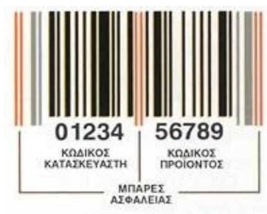
Εικόνα 3. Η ανατομία της μορφής ενός τυπικού barcode.
