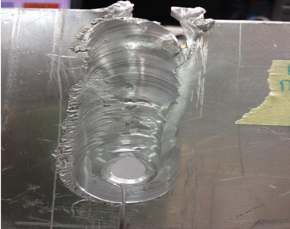
Εικόνα 7.22: Τελικό αποτέλεσμα πέμπτου πειράματος συγκόλλησης τριβής με ανάδευση (FSW).
