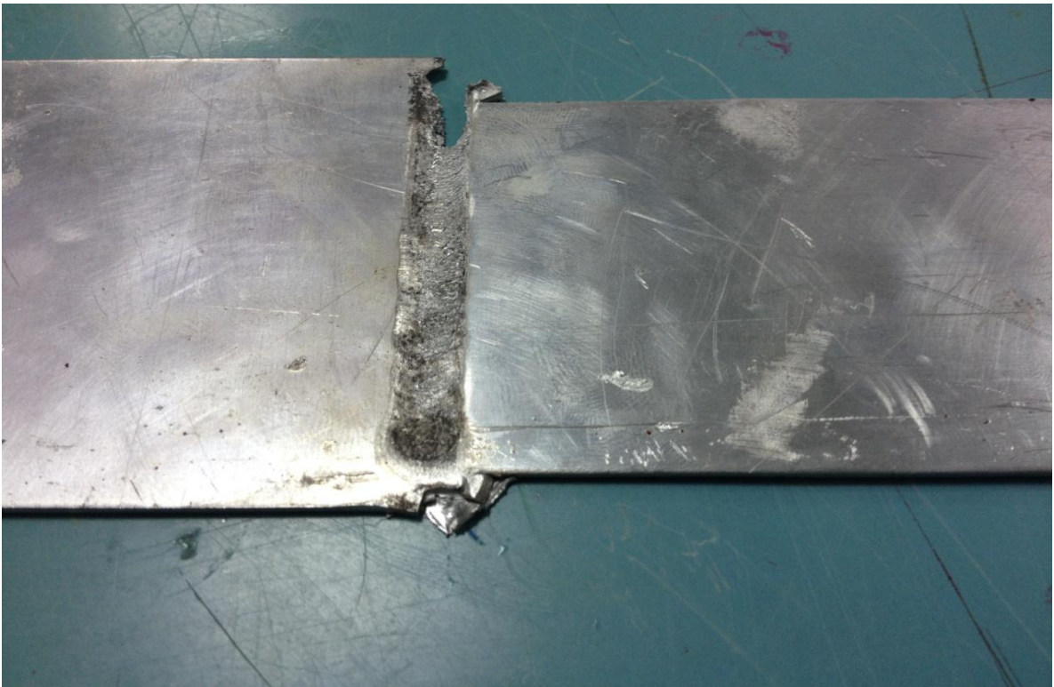
Εικόνα 7.15: Τελικό αποτέλεσμα πρώτου πειράματος συγκόλλησης τριβής με ανάδευση (FSW).
