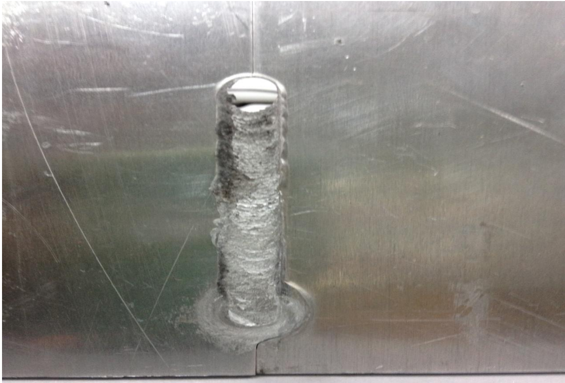
Εικόνα 7.17: Τελικό αποτέλεσμα δεύτερου πειράματος συγκόλλησης τριβής με ανάδευση (FSW).
