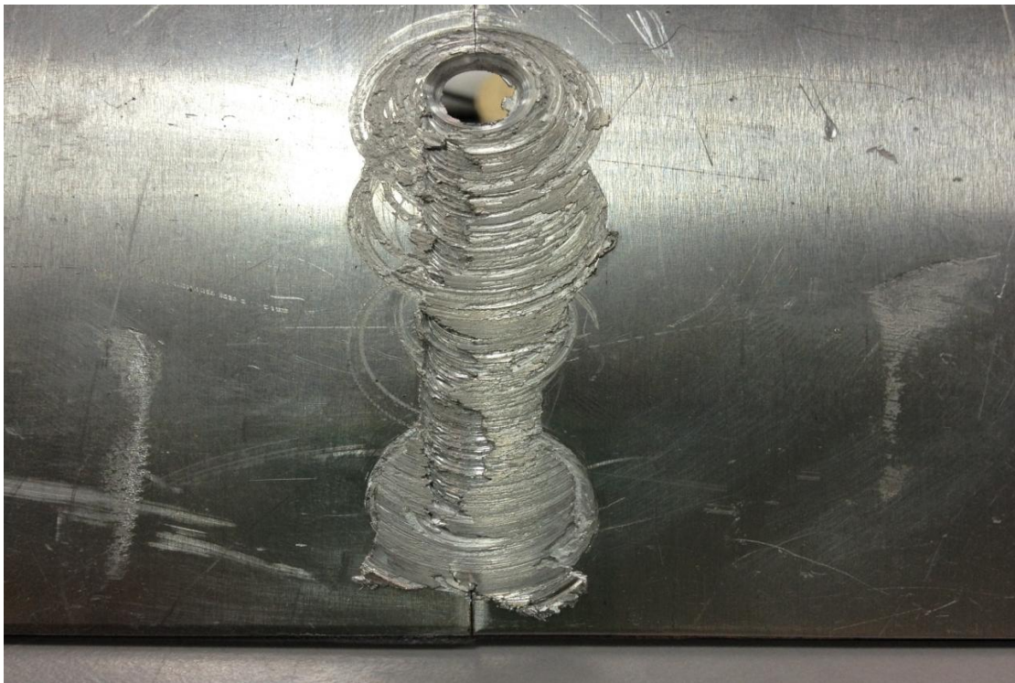
Εικόνα 7.16: Τελικό αποτέλεσμα δεύτερου πειράματος συγκόλλησης τριβής με ανάδευση (FSW).
