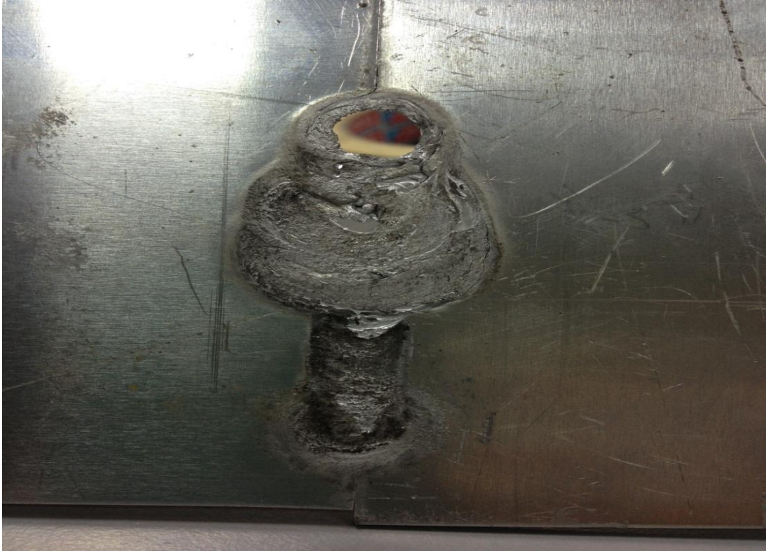
Εικόνα 7.21: Τελικό αποτέλεσμα τέταρτου πειράματος συγκόλλησης τριβής με ανάδευση (FSW).
