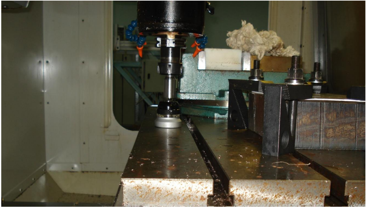
Εικόνα 7.12: Μηδενισμός του εργαλείου συγκόλλησης FSW με Taster.
