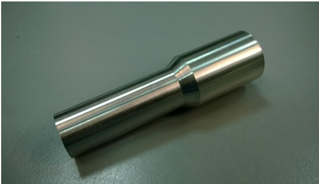
Εικόνα 7.5: Τελική μορφή του εργαλείου συγκόλλησης τριβής με ανάδευση (FSW) .
