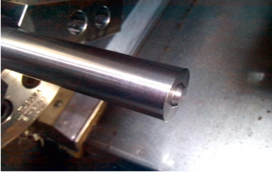
Εικόνα 7.4: Δημιουργία κώνου του εργαλείου συγκόλλησης τριβής με ανάδευση (FSW).
