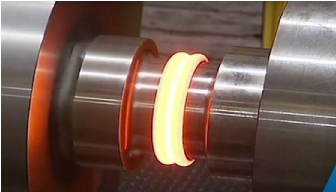
Εικόνα 3.2: Διαδικασία συγκόλλησης τριβής με περιστροφή (RFW).
