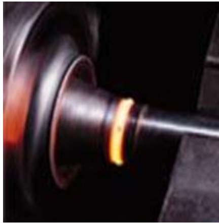
Εικόνα 3.5: Πρώτο στάδιο συγκόλλησης τριβής με περιστροφή (RFW).
