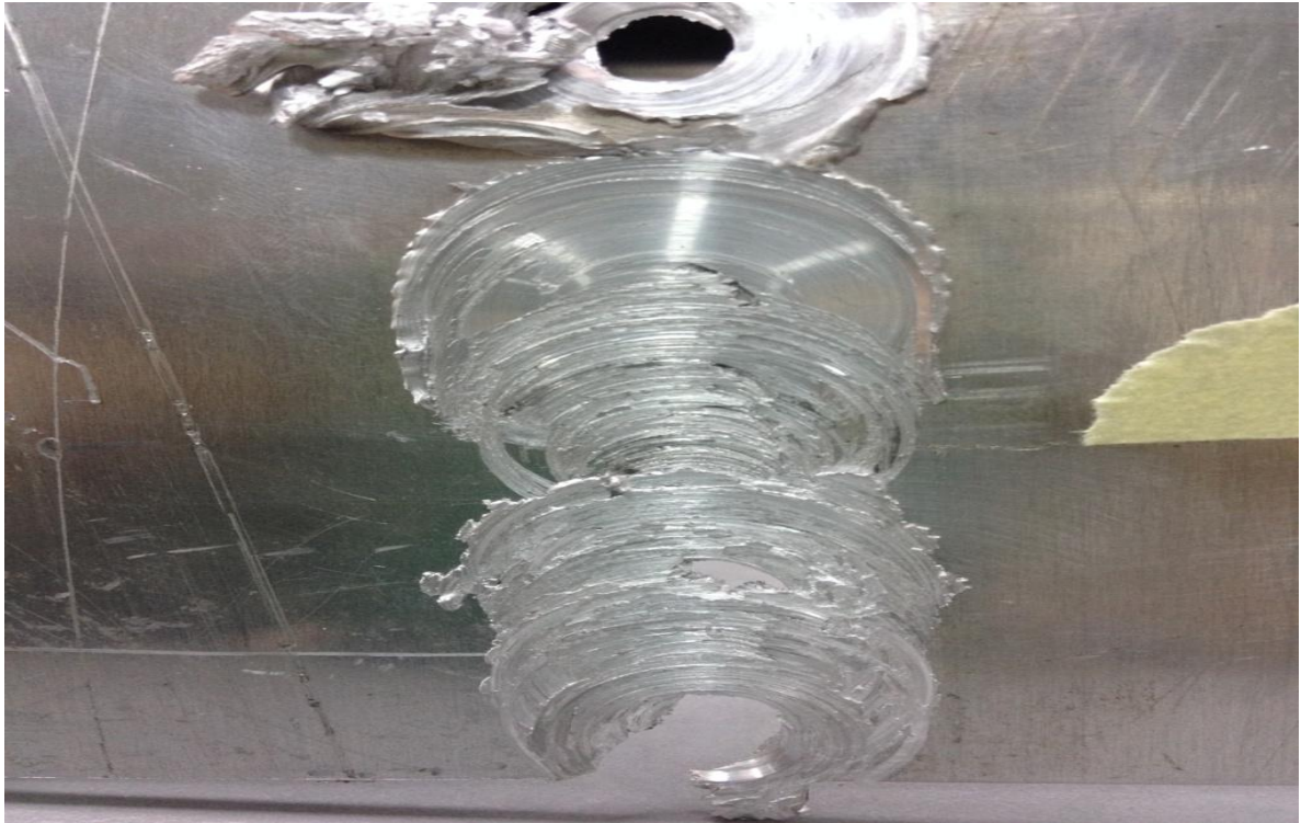
Εικόνα 7.18: Τελικό αποτέλεσμα τρίτου πειράματος συγκόλλησης τριβής με ανάδευση (FSW).
