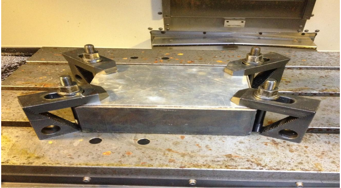
Εικόνα 7.7: Βάση για την τοποθέτηση των ελασμάτων για τη διαδικασία συγκόλλησης τριβής με ανάδευση (FSW).
