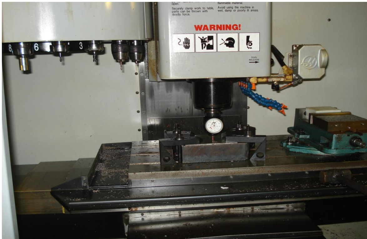
Εικόνα 7.11: Μηδενισμός πάνω στην επιφάνεια κατεργασίας με Taster.
