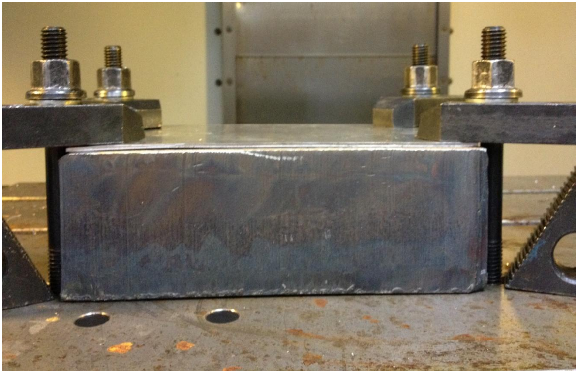
Εικόνα 7.8: Βάση για την τοποθέτηση των ελασμάτων για τη διαδικασία συγκόλλησης τριβής με ανάδευση (FSW).
