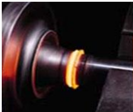
Εικόνα 3.6: Δεύτερο στάδιο συγκόλλησης τριβής με περιστροφή (RFW).
