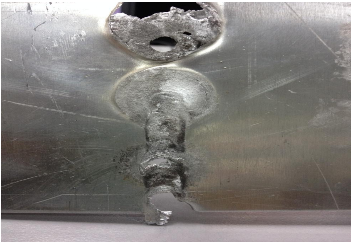
Εικόνα 7.19: Τελικό αποτέλεσμα τρίτου πειράματος συγκόλλησης τριβής με ανάδευση (FSW).
