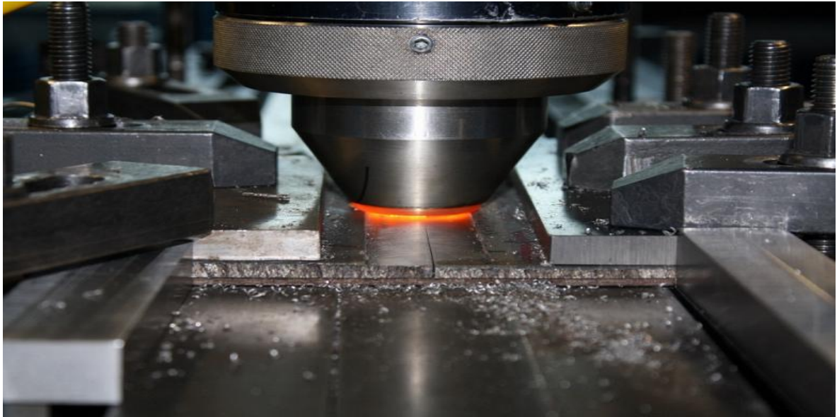
Εικόνα 6.3: Διαδικασία συγκόλλησης τριβής με ανάδευση (FSW) μεταξύ δύο τεμαχίων χάλυβα.
