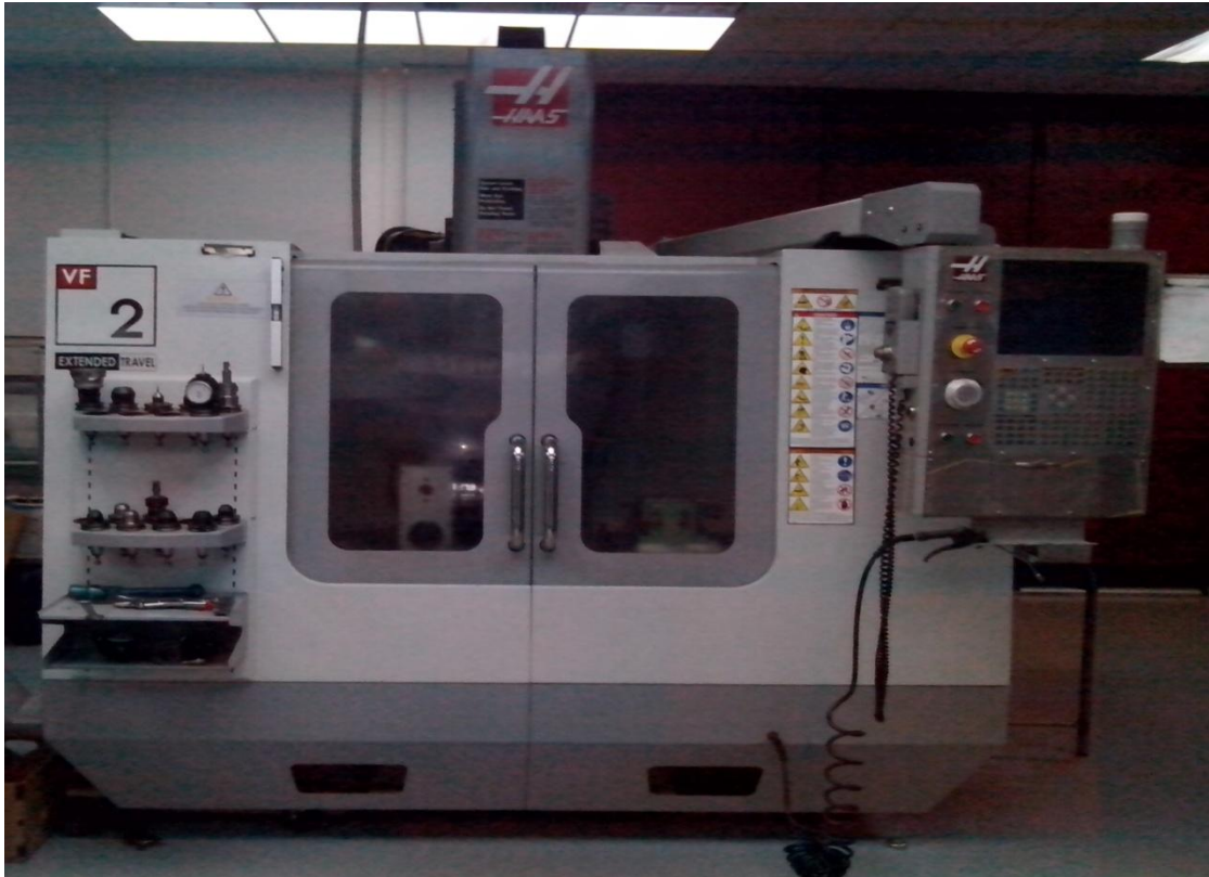
Εικόνα 7.9: Η εργαλειομηχανή CNC (φρέζα) που χρησιμοποιήθηκε στον χώρο του εργασηρίου για την πειραματική διαδικασία της συγκόλλησης τριβής με ανάδευση (FSW).
