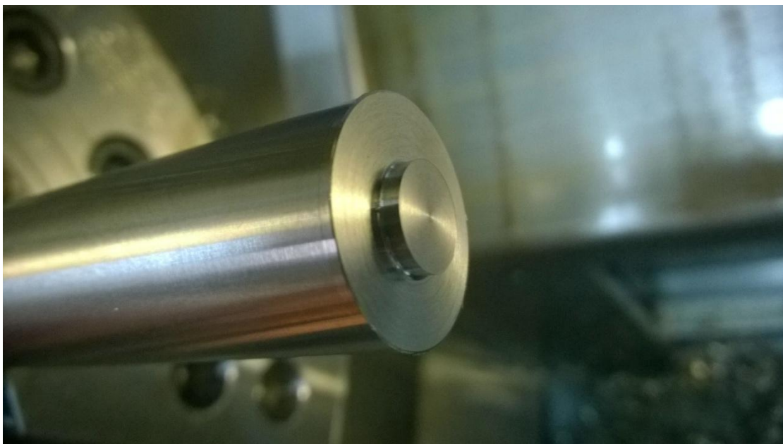
Εικόνα 7.3: Διαδικασία κατασκευή του κώνου του εργαλείου συγκόλλησης τριβής με ανάδευση (FSW) .
