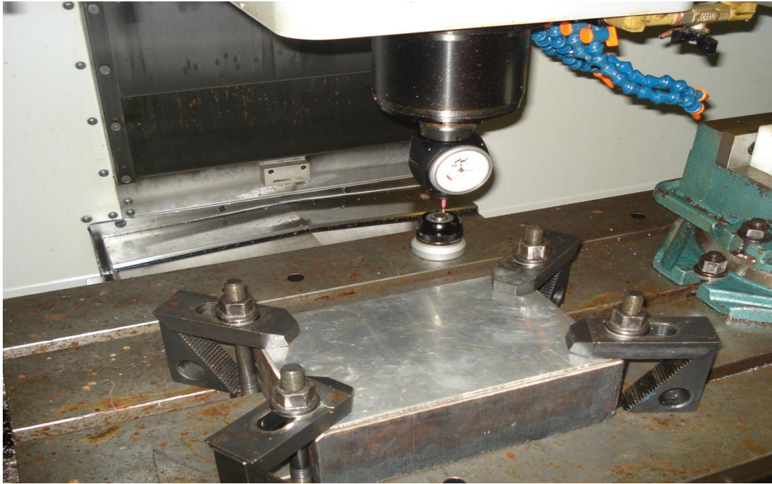
Εικόνα 7.10: Μηδενισμός εργαλειομηχανής CNC με τη βοήθεια Taster.
