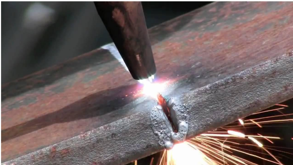
Εικόνα 1.1: Διαδικασία συγκόλλησης με οξυγονοασετυλίνη (Οξυγονοκόλληση).
