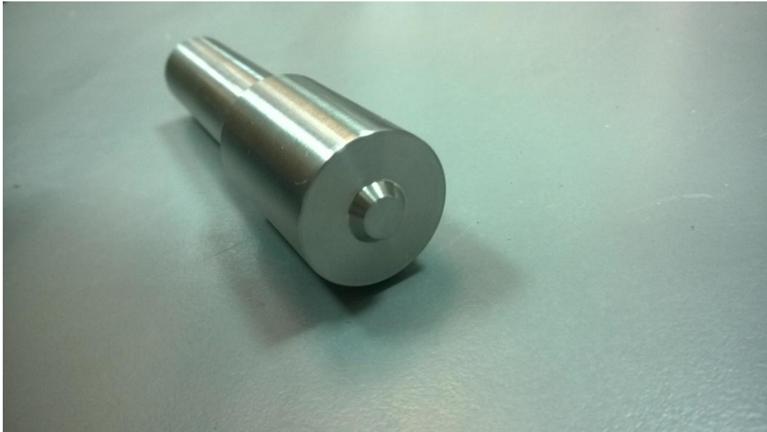
Εικόνα 7.6: Τελική μορφή του εργαλείου συγκόλλησης τριβής με ανάδευση (FSW).
