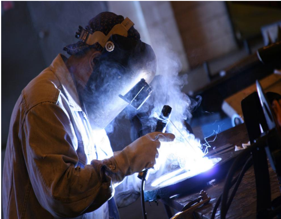
Εικόνα 1.2: Διαδικασία συγκόλλησης τόξου ή ηλεκτροσυγκόλλησης.
