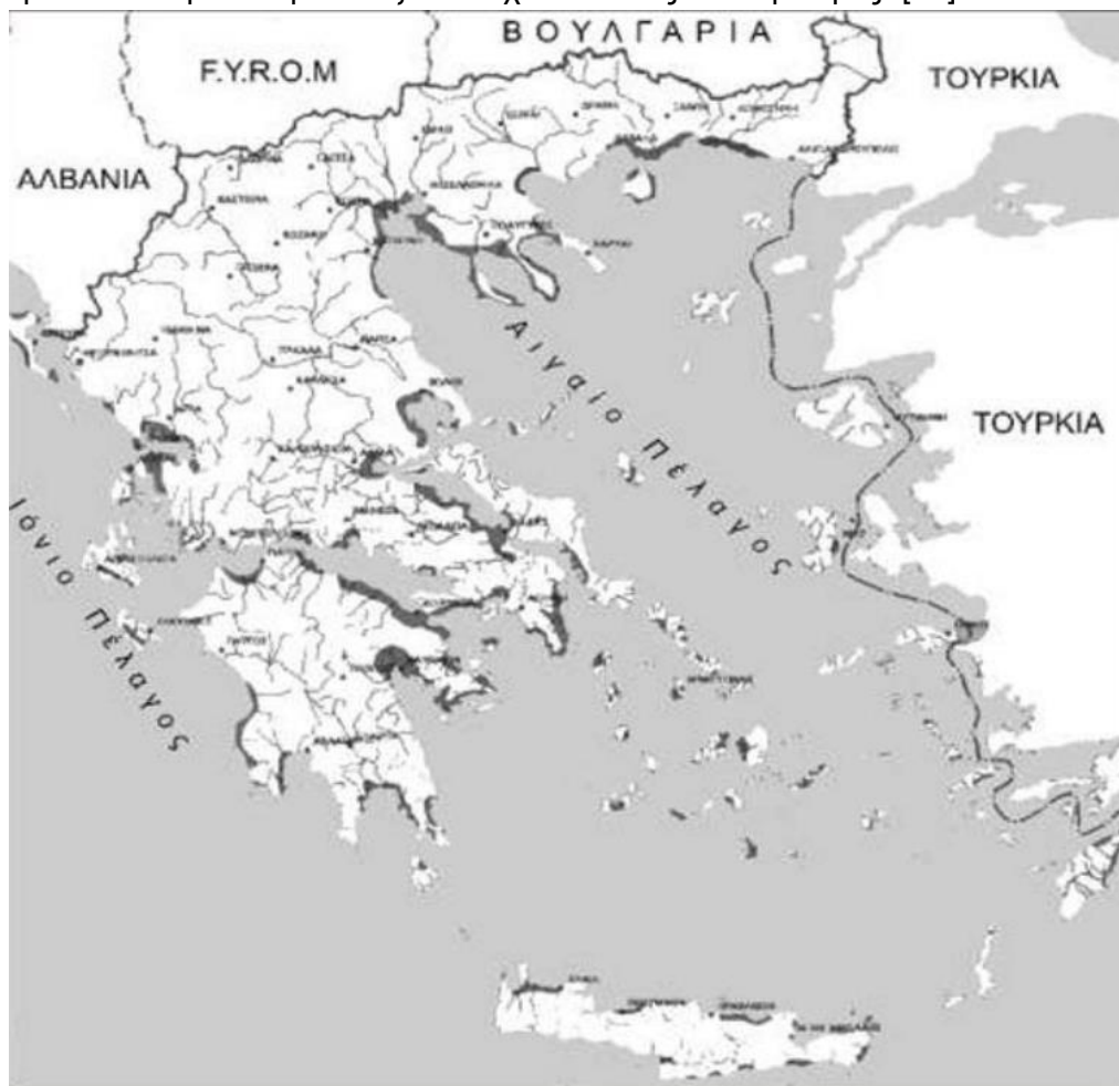
Εικόνα 5 : περιοχές που κινδυνεύουν από τη διείσδυση της θάλασσας λόγω υπεράντλησης.[15]
