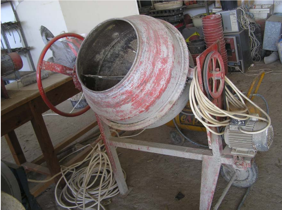
Φωτογραφία 2.2. Η μπετονιέρα που χρησιμοποιήθηκε στη μίξη των συστατικών των υποστρώματων
