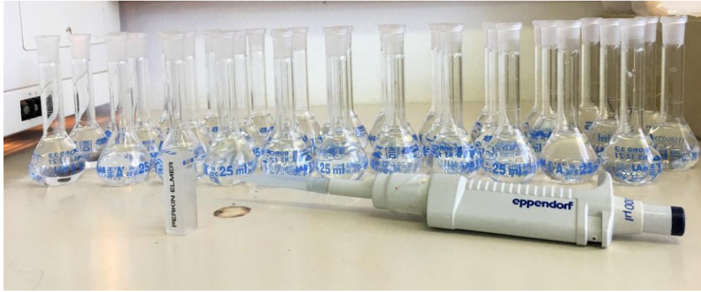
Εικόνα 11: Διαλύματα εδάφους προς μέτρηση κατά τη μέθοδο προσδιορισμού της συγκέντρωσης του \text{NO}_3^- \text{-N} (Φωτο: Ε. Δρακακάκη)
