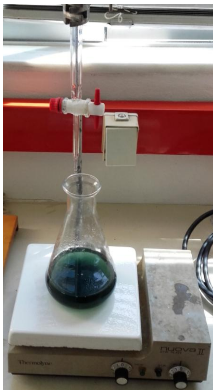
Εικόνα 7: Χαρακτηριστικό πράσινο χρώμα που σηματοδοτεί το τέλος της ογκομέτρησης (Φωτο: Ε. Δρακακάκη)
