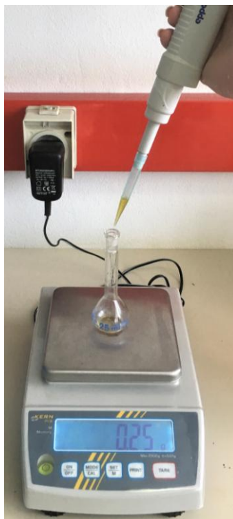
Εικόνα 15: Ακριβής ζύγιση δείγματος ελαιολάδου (Φωτο: Ε. Δρακακάκη)
