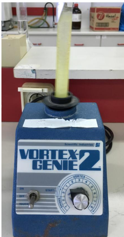
Εικόνα 16: Έντονη ανακίνηση διαλύματος με τη βοήθεια μηχανικών μέσων (Φωτο: Ε. Δρακακάκη)
