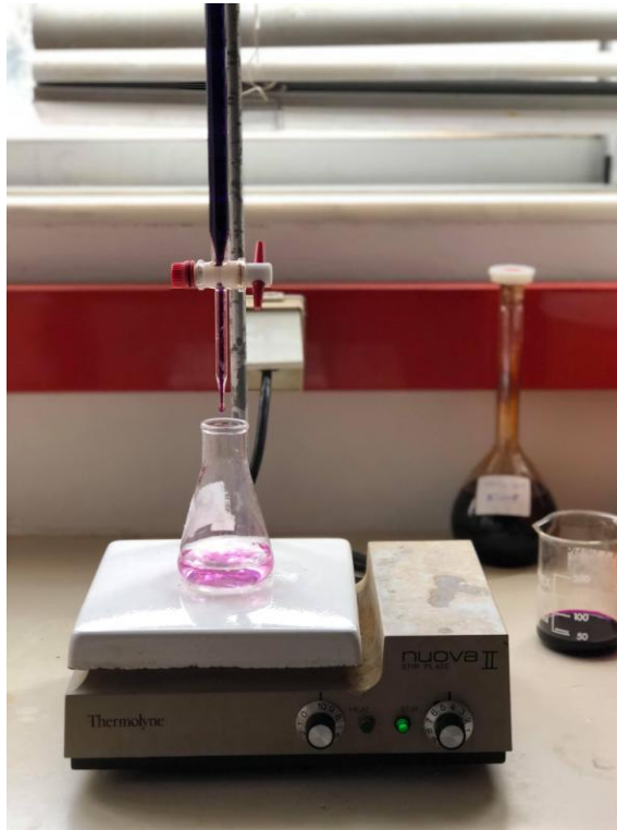
Εικόνα 6: Χρώμα του διαλύματος που ορίζει το τέλος της ογκομέτρησης (Φωτο: Ε. Δρακακάκη)
