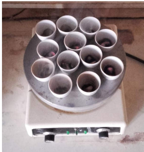
Εικόνα 3: Πρόκαυση φύλλων ελιάς σε πλάκα θέρμανσης (Φωτο: Ε. Δρακακάκη)
