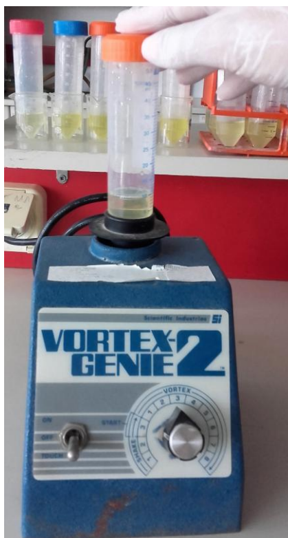
Εικόνα 13: Ανακίνηση διαλυμάτων κατά τον προσδιορισμό του Β στα φύλλα ελιάς (Φωτο: Ε. Δρακακάκη)
