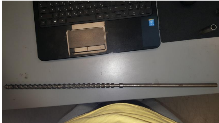
Εικόνα 61: Ο κοχλίας μεταφοράς του υλικού σε όλο του το μήκος.
