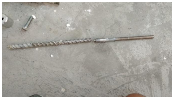
Εικόνα 80: Ένας από τους σπασμένους κοχλίες μεταφοράς του υλικού.
