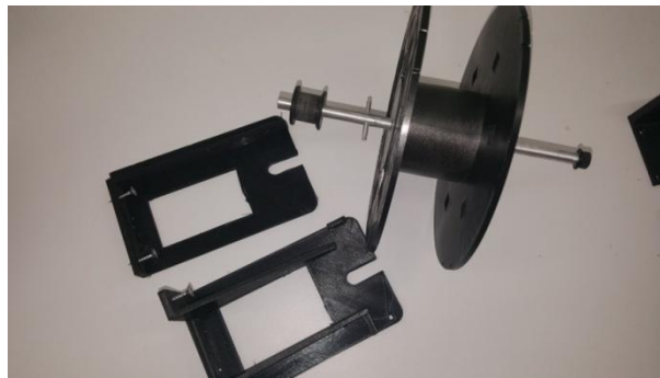
Εικόνα 72: Το συναρμολογημένο καρούλι τυλίξεως νήματος και τα στηρίγματα του.
