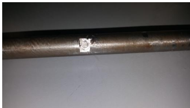
Εικόνα 60: Η εγκοπή που εξασφαλίζει την ασφάλιση του οδοντωτού τροχού πάνω στον κοχλία.
