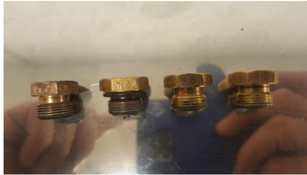
Εικόνα 56: Τα διαθέσιμα ακροφύσια διαφορετικών διατομών (2mm, 1,8mm και 1,5mm) του εργαστηρίου.
