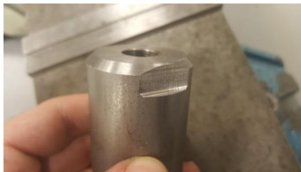
Εικόνα 57: Το αυλάκι στο ακροφύσιο για τη χρήση κλειδιού.
