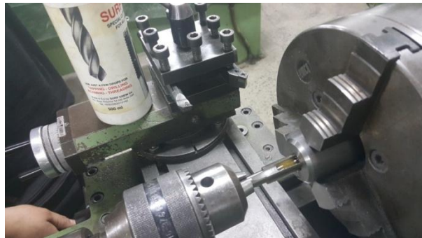
Εικόνα 55: Η κατεργασία του σπειρώματος για το μπεκ με κολαούζο σε τόρνο του εργαστηρίου.
