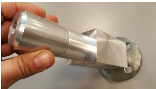
Εικόνα 53: Όπως φαίνεται στην εικόνα η κεφαλή του extruder διαχωρίζεται από τον κύλινδρο συμπίεσης και τήξης, διαθέτει επίσης και την οπή για να βιδωθεί το μπεκ.
