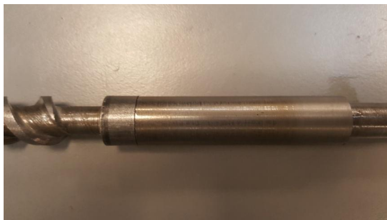
Εικόνα 62: Ο αποστάτης περασμένος στον κοχλία και η σωστή εφαρμογή του.
