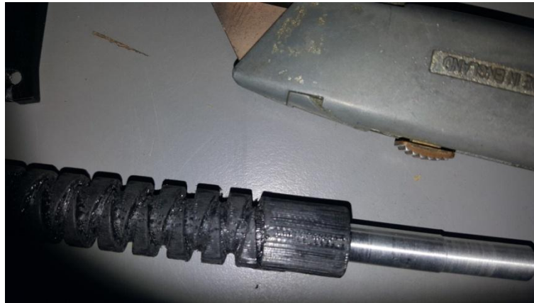
Εικόνα 70: Στο δεξιό άκρο του άξονα φαίνεται μειωμένη διατομή του, αλλά και η ανομοιομορφία του οδοντωτού τροχού.
