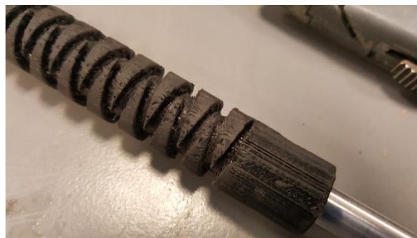
Εικόνα 85: Ο οδοντωτός τροχός με την ανεπιθύμητη εσοχή στο τελείωμα του σπειρώματος.
