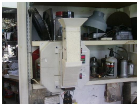
Εικόνα 89: Ο κάθετος extrudertου Hugh Lyman με ονομασία V6.
