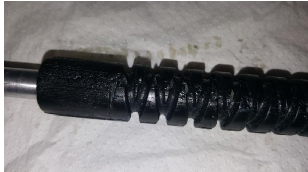
Εικόνα 86: Ο οδοντωτός τροχός με διορθωμένη την ανεπιθύμητη εσοχή, καλυμμένος με γράσο.
