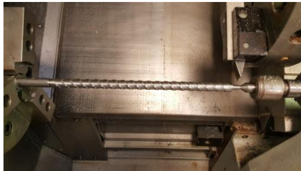
Εικόνα 59: Η κατεργασία του κοχλίας στον τόρνο τεσσάρων αξόνων του εργαστηρίου.
