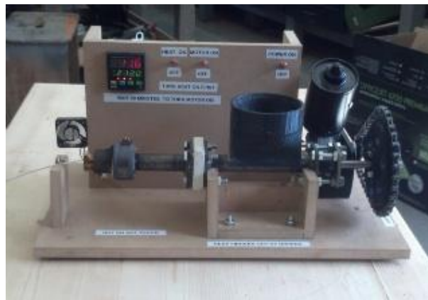
Εικόνα 12: Η πρώτη μηχανή συρματοποίησης του Hugh Lyman.
