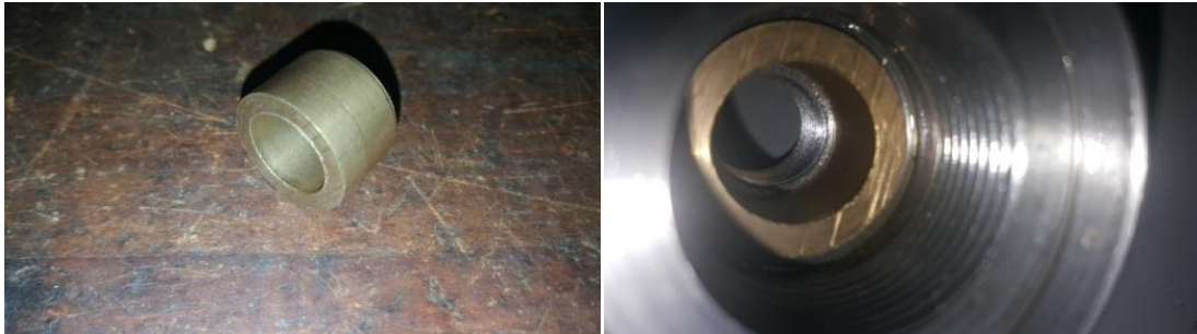
Εικόνα 58: Αριστερά στο ορειχάλκινο δαχτυλίδι μετά στην κατεργασία του και δεξιά προσαρμοσμένο στο ακροφύσιο.
