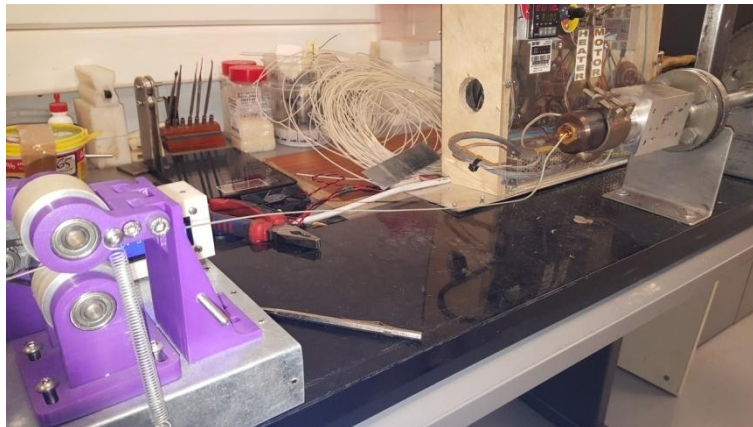
Εικόνα 94: Η λειτουργία του extruder και του τραβηχτικού κατά τη διαδικασία παραγωγής νήματος.
