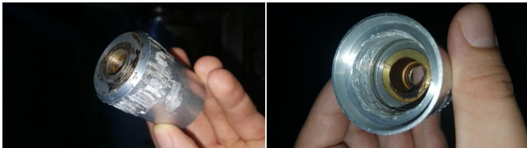
Εικόνα 82: Στην αριστερή εικόνα είναι εμφανής οι εκδορές στο εξωτερικό τμήμα του ακροφυσίου και στην αριστερή το αλλοιωμένο σπείρωμα.
