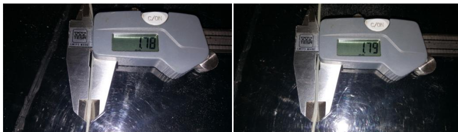
Εικόνα 93: Μέτρηση της διατομής του παραγόμενου νήματος.
