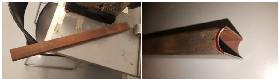
Εικόνα 63: Στην αριστερή εικόνα παρουσιάζεται η ακατέργαστη ορθογώνια σωλήνα και στη δεξιά η καθαρισμένη και κομμένη στην CNC σωλήνα για τη διαμόρφωση του ημικυκλίου.
