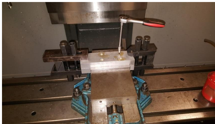
Εικόνα 51: Κατεργασία για τη δημιουργία οπών στις πλάκες αλουμινίου, ενώ παραμένουν δεμένες στη μέγγενη.
