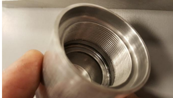
Εικόνα 54: Στην εικόνα παρουσιάζεται η εσωτερική κατεργασία για τη διαμόρφωση του σπειρώματος του ακροφυσίου στον τόρνο.
