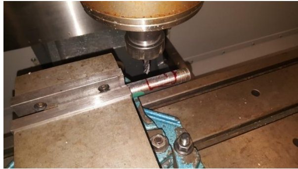
Εικόνα 64: Η κατεργασία του κυλίνδρου για τη διάνοιξη οπής στην CNC μηχανή.
