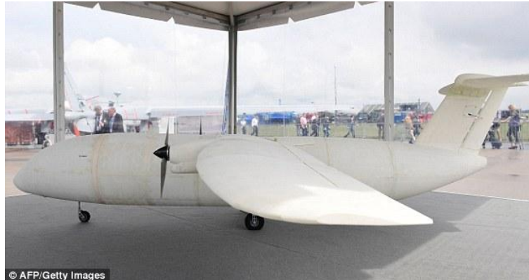
Εικόνα 4: Το πρώτο 3D εκτυπωμένο αεροσκάφος χωρίς παράθυρα βάρους 21 κιλών και μήκους 4 μέτρων.
