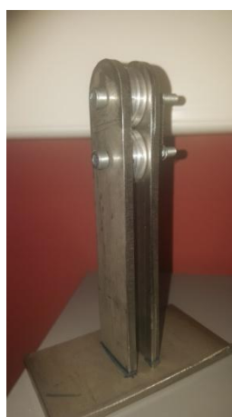
Εικόνα 67: Η συναρμολογημένη κατασκευή των ράουλων.
