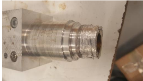
Εικόνα 81: Ο κύλινδρος συμπίεσης και τήξης του υλικού με το αλλοιωμένο σπείρωμα.
