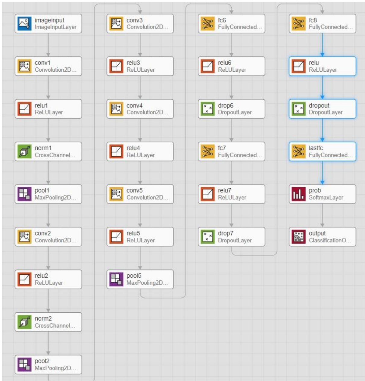
Εικόνα 17 – Δομή AlexNet με την προσθήκη επιπλέον Fully Connected στρώματος
