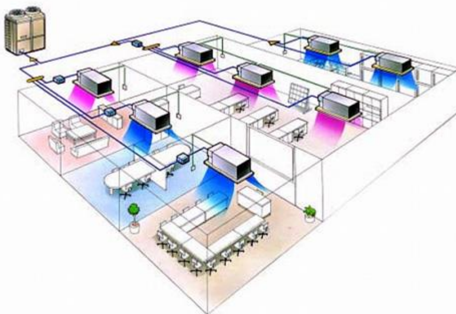
Εικόνα 95 : Εγκατεστημένο σύστημα VRV σε κτήριο
