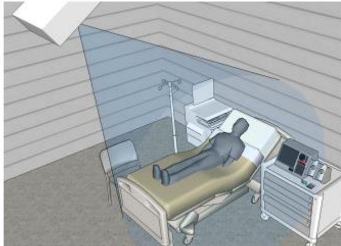
Εικόνα 9: Τοποθέτηση κάμερες για ολονύχτια καταγραφή.[Πηγή: T. Grimm, M. Martinez, A.Benz,R. Stiefelhagen, Sleep position classification from a depth camera using Bed Aligned Maps, 23rd International Conference on Pattern Recognition (ICPR 2016), 4-8 Dec. 2016, Cancun, Mexico, DOI: 10.1109/ICPR.2016.7899653 ]
